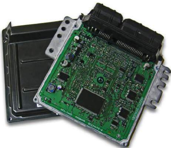
Fotografia 6. Wygląd i budowa sterownika ECU
