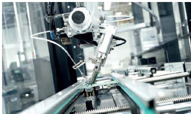
Fotografia 10. Głowica robota lutowniczego Reeco RE-2100 ( https://t.ly/iod0 )
