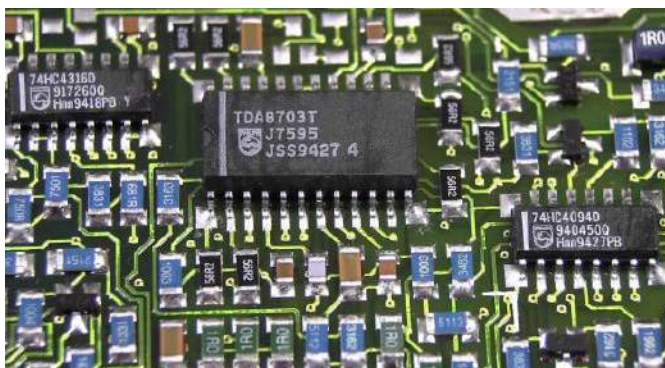
Fotografia 4. Obwód drukowany o małej gęstości ułożenia elementów, zaprojektowany zgodnie z wymogami procesu lutowania na fali (widoczne wyraźne poszerzenia padów montażowych – https://t.ly/dnOE )
