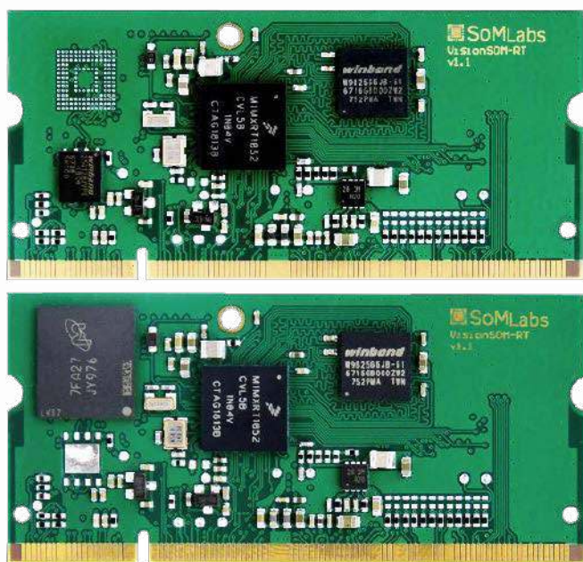
Fotografia 3. Minikomputer SoM z serii VisionSOM-RT – przykład zastosowania wariantów montażowych do zróżnicowania wersji modułu pod względem wbudowanej pamięci ( https://t.ly/TALM )
