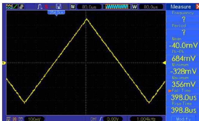
Rysunek 12. Oscylogram pokazujący wyjściowy sygnał trójkątny
