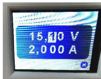
Fotografia 5. Podmenu zmiany wartości napięcia wyjściowego oraz ograniczenia prądowego
