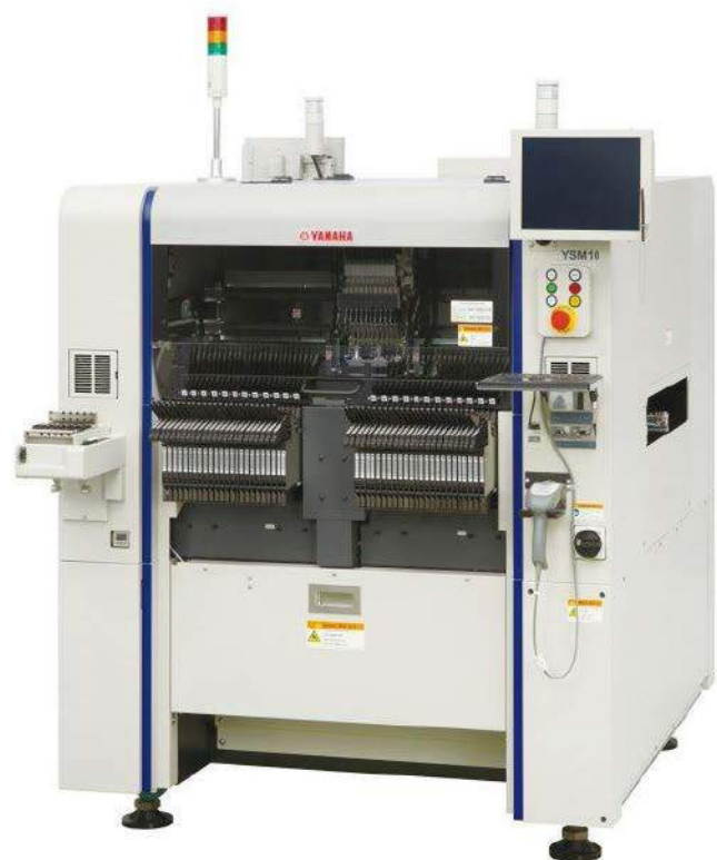
Fotografia 6. Nowoczesny automat montażowy YSM10 marki Yamaha ( https://t.ly/Jtbx )
