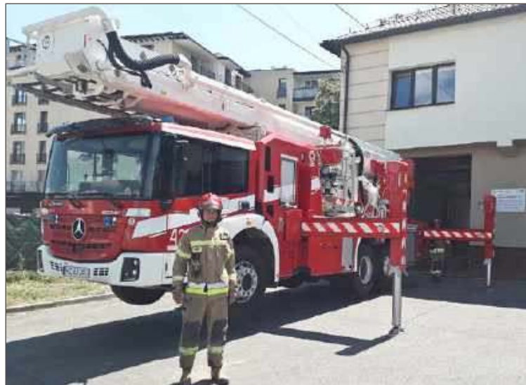
Ten samochód wymaga stabilnego podłoża, wtedy można rozłożyć podnośnik.
