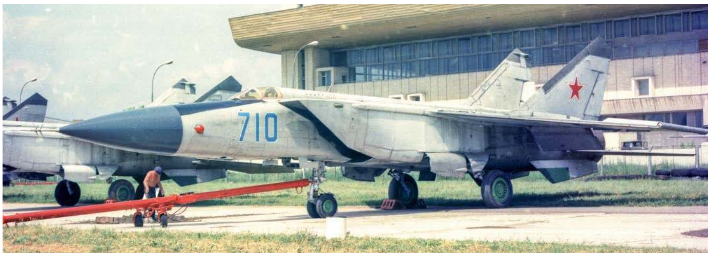
MiG-25M różnił się od seryjnych MiG-ów-25P szeregiem dopracowanych detali płatowca (częścią nosową, końcówkami skrzydeł, lotkami) oraz potężniejszymi silnikami R15BF2-300.
