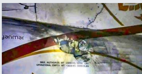
Uszkodzenie kadłuba w samolocie pasażerskim ATR 72-600 linii lotniczych Myanmar National Airlines. Fot. x.com/@aviationbrk
