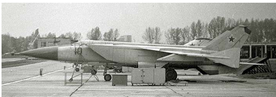
Pierwsze prototypy Je-155P miały zamontowane na końcówkach skrzydeł charakterystyczne płetwy służące do zwiększenia stateczności.
