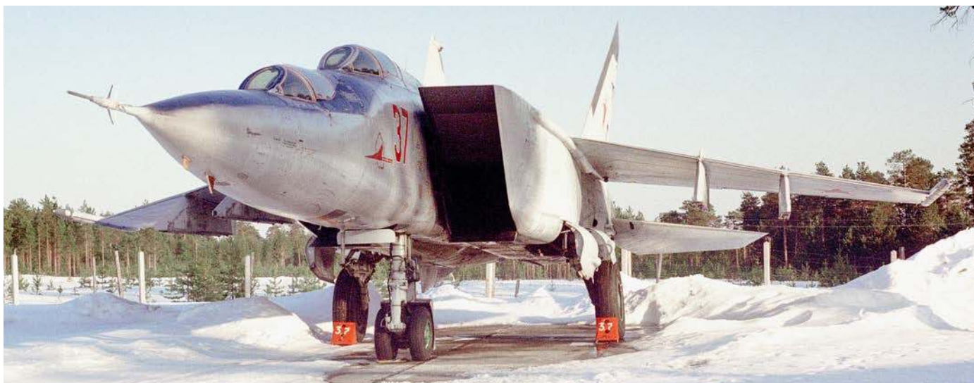
W samolocie MiG-25PU miejsce dla kabiny instruktora wygospodarowano dzięki usunięciu radaru.
