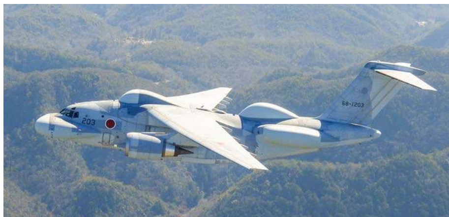
Japoński EC-2 w powietrzu podczas dziewiczego lotu. Dobrze widoczne są górne anteny zbierające i zakłócające sygnał satelitarny. Fot. JASDF
