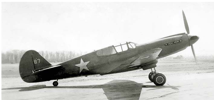
Pierwszy prototyp XP-40Q w początkowej konfiguracji – z silnikiem V-1710-101 i chłodnicami cieczy i oleju umieszczonymi pod kadłubem i przykadłubową częścią skrzydeł. Samolot powstał z przebudowy P-40K-10 (42-9987).
