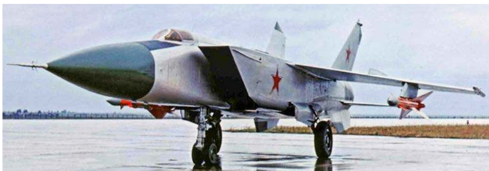
Prototyp Je-155P-1 jeszcze bez płetw na końcówkach skrzydeł, ale z zamontowanymi pod skrzydłami pojedynczymi pylonami z makietami masowo-gabarytowymi pocisków K-40.
