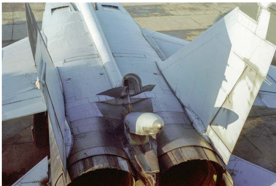
Do skrócenia dobiegu wykorzystywano spadochrony hamujące. Na zdjęciu pokazano kontener spadochronów w położeniu otwartym.
