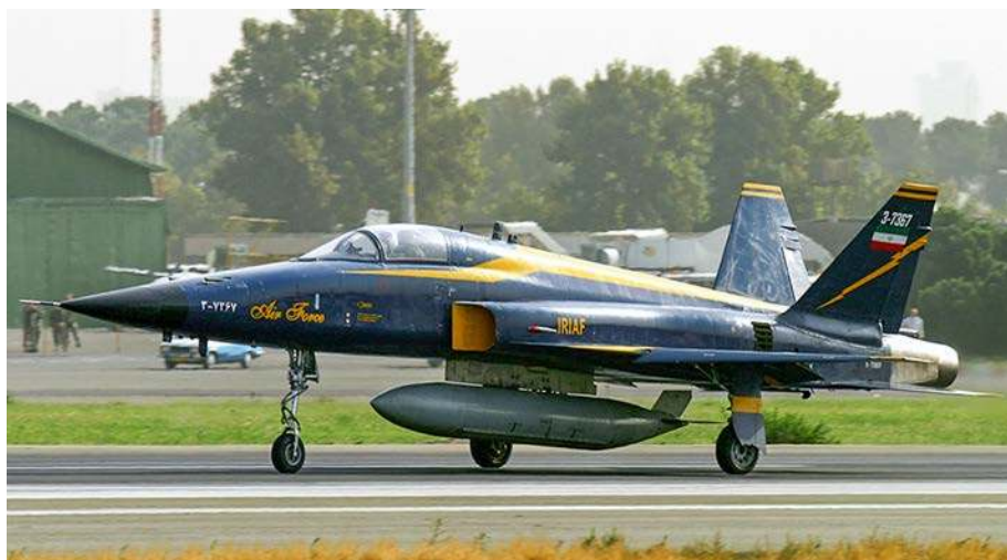
Jedną z irańskich modernizacji samolotów F-5E/F jest Saeqeh , wyróżniający się podwójnym usterzeniem pionowym. Zbudowano sześć jednomiejscowych F-5E Saeqeh (na zdjęciu) i jeden dwumiejscowy F-5F Saeqeh II .
