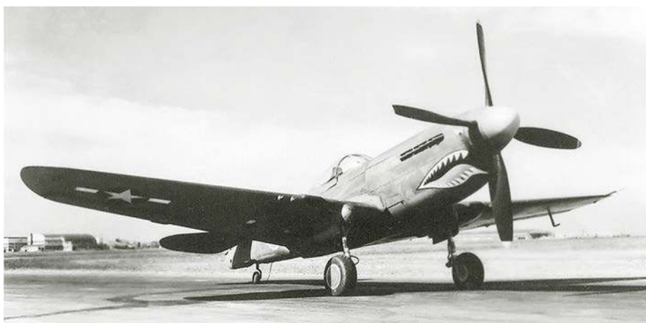
Pierwszy prototyp XP-40Q w pośredniej konfiguracji – z obniżonym grzbietem kadłuba, kropłową osłoną kabiny, chłodnicami cieczy w skrzydłach oraz chłodnicą oleju i wlotem powietrza do sprężarki we wspólnej obudowie pod silnikiem.
