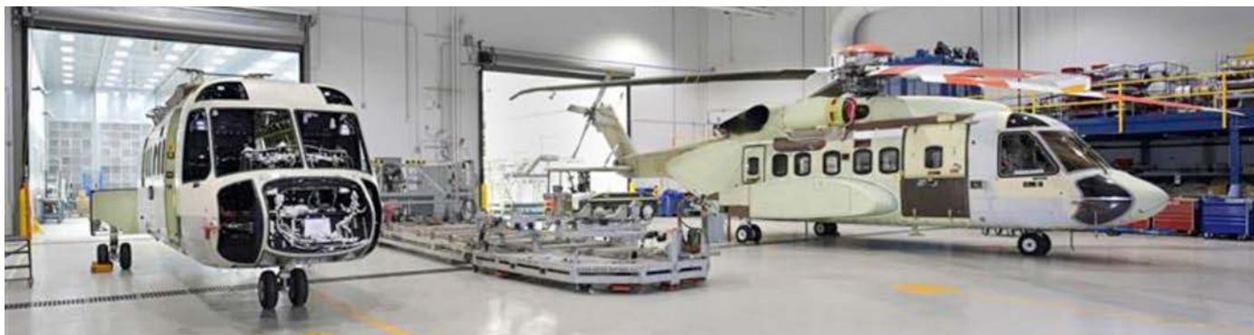
Budowa dwóch egzemplarzy z pierwszej partii pięciu śmigłowców S-92A+.
