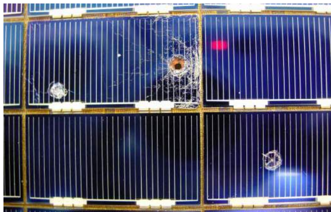
Fotografia 17. Panel solarny Kosmicznego Teleskopu Hubble'a po kolizji z mikroskopijnym meteorytem ( https://t.ly/4gNO )
