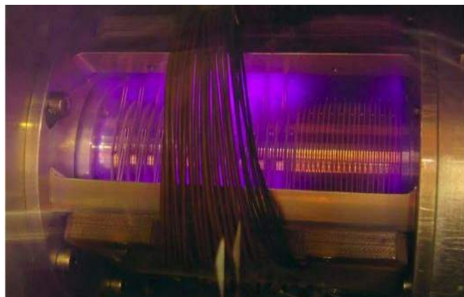
Fotografia 16. Wyładowania koronowe widoczne w rejonie złącza obrotowego panelu słonecznego ( https://t.ly/9tyw )
