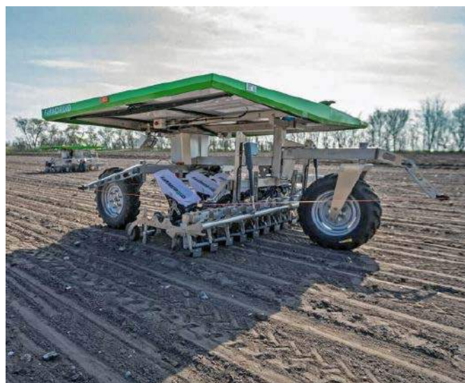
Fotografia 1. Robot FarmDroid FD20, który może działać zasilany w 100% z energii słonecznej
