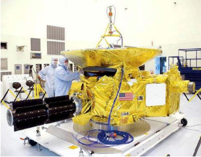
Fotografia 1. Sonda New Horizons w czasie integracji. Dobrze widoczne pokrycia termiczne (żółte płachty) oraz zespół radioizotopowego generatora termoelektrycznego (czarne tubusy w lewym dolnym rogu) https://t.ly/Pbhk
