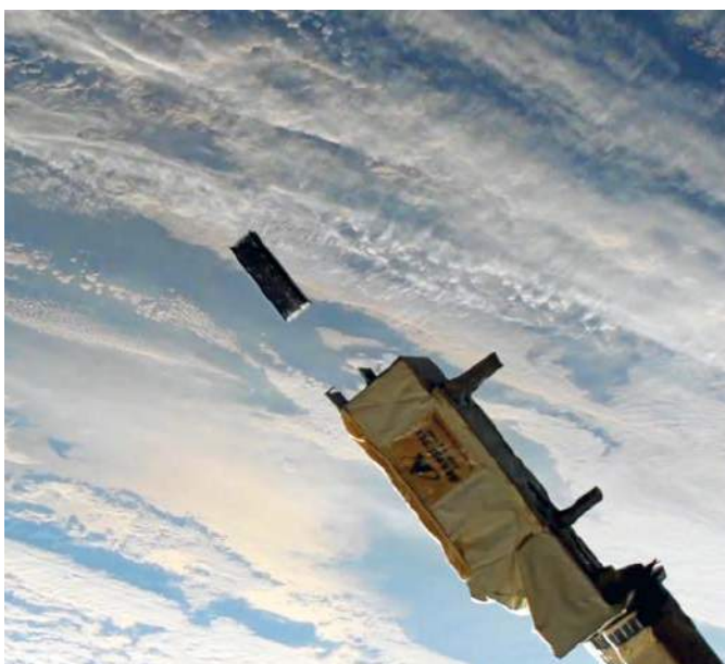
Fotografia 16. CubeSat Phoenix o rozmiarze 3U tuż po wyrzuceniu przez system Nanoracks CubeSat Deployer, zainstalowany na Międzynarodowej Stacji Kosmicznej ( https://t.ly/-MIT )
