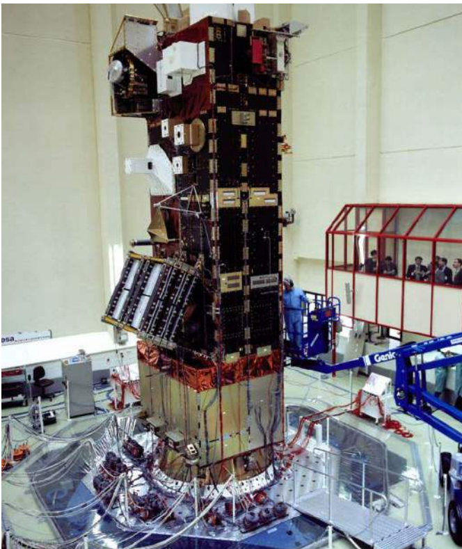
Fotografia 4. Ośmiotonowa (!) konstrukcja satelity Envisat zamontowana na platformie testowej potężnej wytrząsarce wieloosiowej Hydra, znajdującej się w centrum ESTEC ( https://t.ly/CFv1 )
