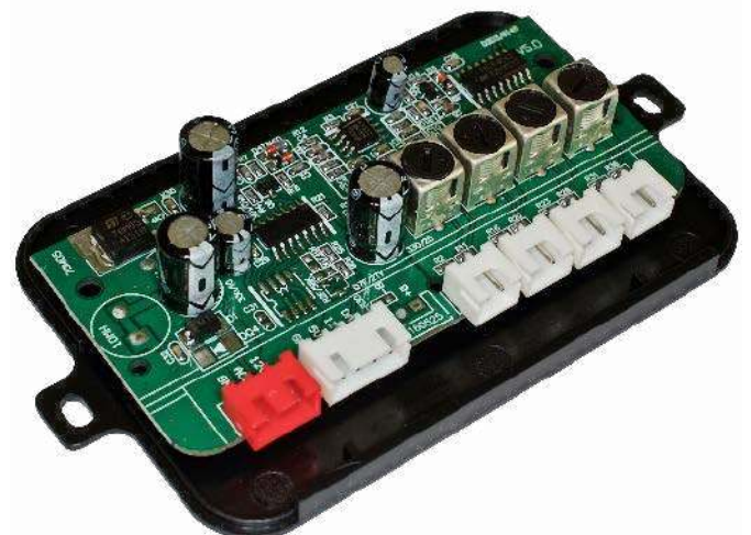
Fotografia 4. PCB systemu czujników parkowania z widocznymi transformatorami IFT przeznaczonymi do obsługi czterech kanałów pomiarowych ( https://t.ly/Kdza )
