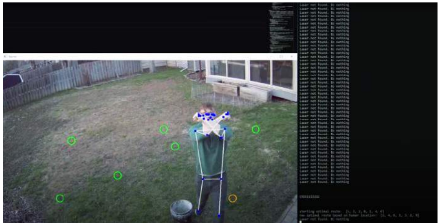
Rysunek 4. Sygnał rozpoczęcia zbierania odchodów. Algorytm rozpoznaje postać człowieka i wykrywa, gdy skrzyżuje on przed sobą ręce
