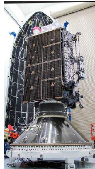
Fotografia 6. Satelita GPS-3 podczas integracji ( https://t.ly/TOD_ )
