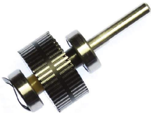
Rysunek 3. Wirnik hybrydowego silnika krokowego NEMA 17 z silnika o 200-krokach z widocznymi dwoma sekcjami wirnika, każda po 50 zębów. Przyjrzyj się uważnie, a powinieneś zobaczyć, że zęby obu sekcji wirnika są przesunięte względem siebie o pół skoku ( 3,6^\circ ), tworząc efektywnie wirnik o 100 zębach.
