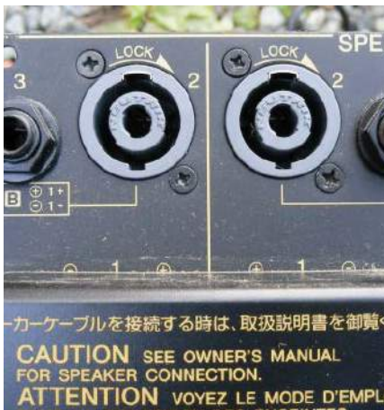
Rysunek 39. Gniazda Speakon na wzmacniaczu mocy Yamaha. Wtyki należy obrócić po wpięciu do gniazda, aby zablokować połączenie.
