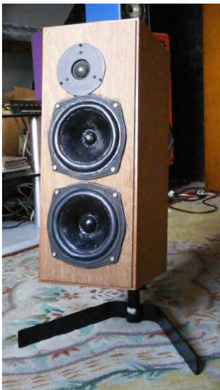
Rysunek 42. Niskie standy AVF, odpowiednie do wyłożonych wykładziną dywanową małych pomieszczeń. Mają regulowany kąt, aby skierować oś głośnika do góry, co pozwala uniknąć zakłóceń w zwrotnicy.
