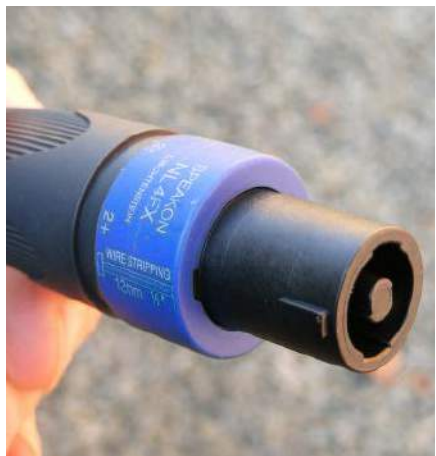
Rysunek 38. Wtyk Speakon – złącze profesjonalne. Polaryzacja jest wyraźnie zaznaczona. Większość ma wewnątrz zaciski śrubowe.
