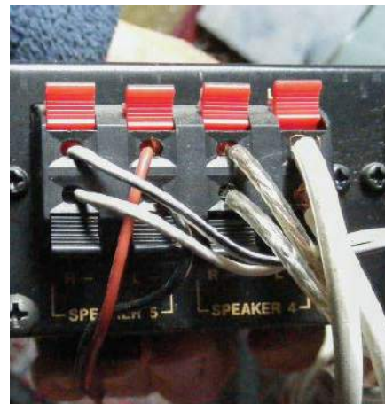
Rysunek 34. Zaciski sprężynowe są często stosowane do głośników w tanim sprzęcie; na przykład w tej skrzynce przełączającej głośniki.
