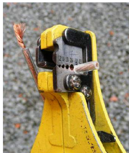
Rysunek 29. Zwróć uwagę, że okrągłe ostrze ściągacza izolacji Rolsona nie nacinają żył kabla CPC z rysunku 26 .
