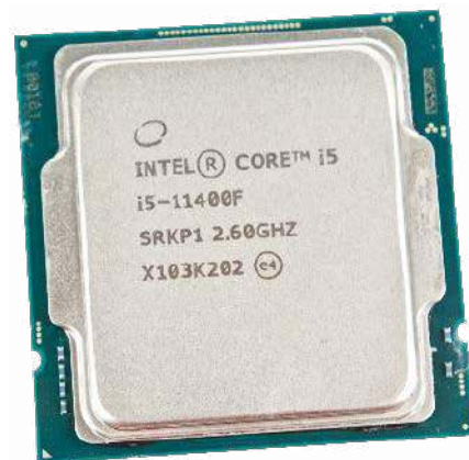
Rysunek 7. Przykładowy mikroprocesor do PC-tów, Intel Core i5 11400(F), dostępny w cenie ok. 800 zł
