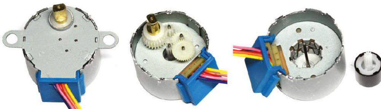
Rysunek 2. Widok wewnętrzny silnika krokowego z magnesem trwałym 28BYJ-48 z wbudowaną przekładnią. Należy zwrócić uwagę na 'palce' wokół wewnętrznej strony stojana dające 32 kroki na obrót. Liczba kroków na wale wyjściowym wynosi w przybliżeniu \ast 32 \times \text{przełożenie przekładni } 64 = 2048 w trybie full-step. (*uwaga, że przełożenie przekładni nie wynosi dokładnie 64:1).
