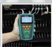
pomiar długości przewodu; lokalizacja punktu przerwania
