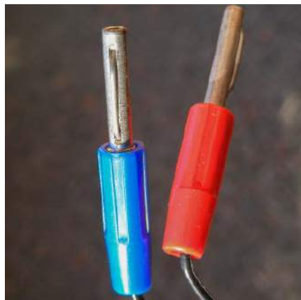
Rysunek 33. Wtyki bananowe zostały wynalezione w latach dwudziestych ubiegłego wieku. Nadal są powszechnie stosowane w systemach głośnikowych (a także w zasilaczach i budżetowych przyrządach laboratoryjnych).
