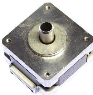
Rysunek 9. Silnik NEMA 17 z wydrążonym wałem – Technobots zastosował je u klienta, który potrzebował silnika do ciągłego obracania w jednym kierunku bardzo jasnego panelu świetlnego LED. Wał silnika napędzał pierścień ślizgowy, który z kolei obracał panel LED. Przewody pierścienia ślizgowego były prowadzone przez wydrążony wał do sterownika LED w taki sposób, że przewody nigdy się nie skręcały.
