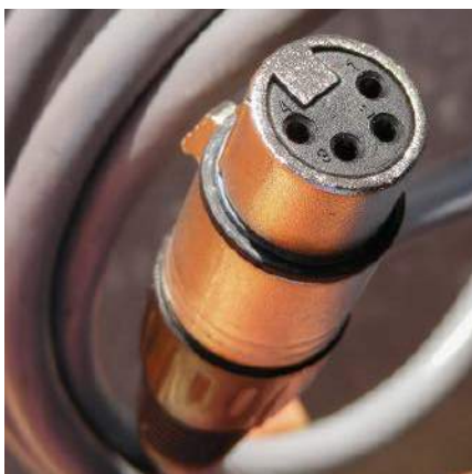
Rysunek 36. W moich małych głośnikach aktywnych stosuję 4-pinowe XLR-y.
