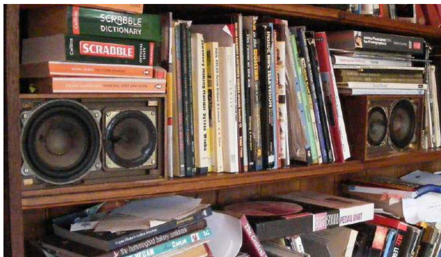
Rysunek 43. Nie należy zabudowywać głośników „półkowych”. Otwarte standy to jedyny sposób na uzyskanie dobrego obrazowania stereo.
