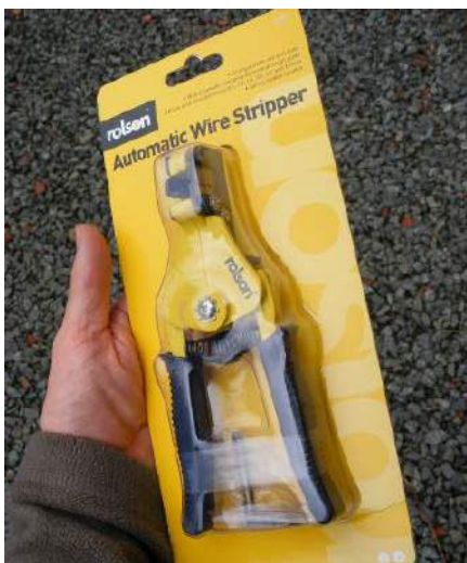
Rysunek 28. Takie ściągacze izolacji z marek Rolson budowlanych są doskonałe do kabli głośnikowych, jak również do okablowania domowego.
