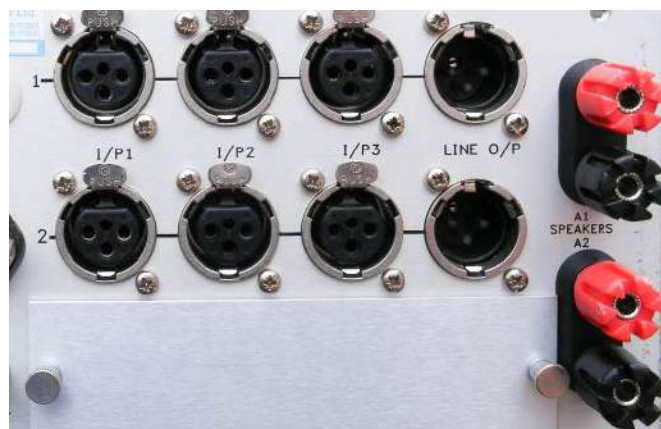
Rysunek 32. Zaciski śrubowe (po prawej) to najczęściej spotykany typ złącza głośnikowego.
