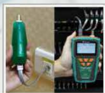
test kabli LAN, telefonicznych i koncentrycznych
