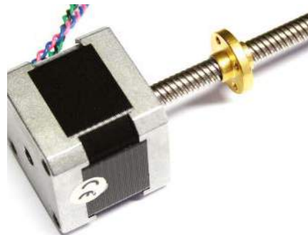
Rysunek 10. Bipolarny silnik krokowy NEMA 17 z wbudowaną śrubą prowadzącą T4 napędzającą mosiężną „nakrętkę”.
