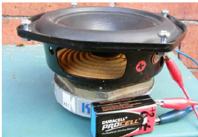
Rysunek 24. Polaryzacja głośnika: (po lewej) dodatnie napięcie na połączeniu plusowym wypycha membranę na zewnątrz; (po prawej) odwrócenie napięcia powoduje jej wciągnięcie.
