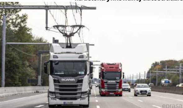
8. Scania R 450 z pantografem na zelektryfikowanej autostradzie
