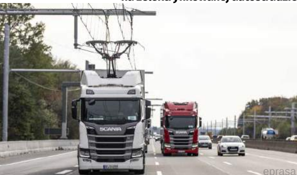
8. Scania R 450 z pantografem na zelektryfikowanej autostradzie
