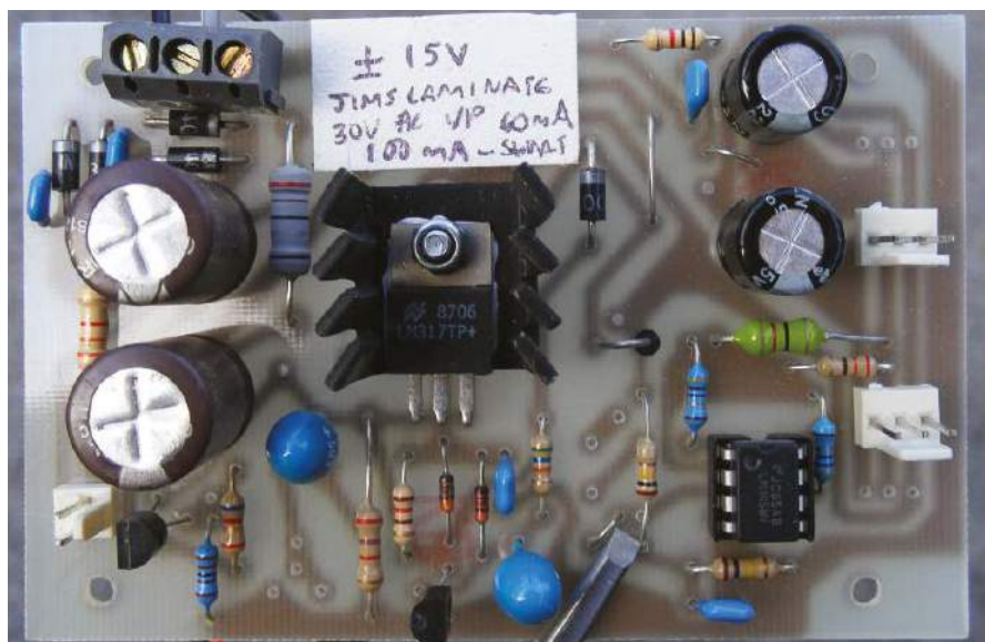
Fotografia 20. Standardowa wersja zasilacza niskopoziomowego \pm 15 V. Ograniczenie małego prądu do 100 mA chroni dwie wzmacniacze operacyjne
