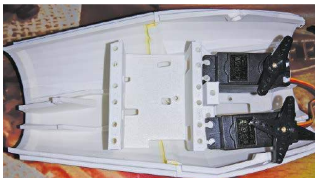
Rysunek 2. Proteza ręki z serwomechanizmem
