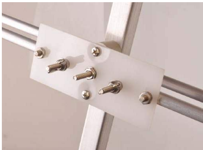
Płytki izolatora dipola ma zaciski z nakrętkami motylkowymi do podłączenia taśmy 300 \Omega lub baluna 300 \Omega na 75 \Omega . Płyta jest wykonana z tworzywa Perspex, Lexan lub innego materiału akrylowego. Kwadratowy wysięgnik ułatwia montaż
