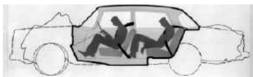
Odporna na deformację kabina pasażerska
