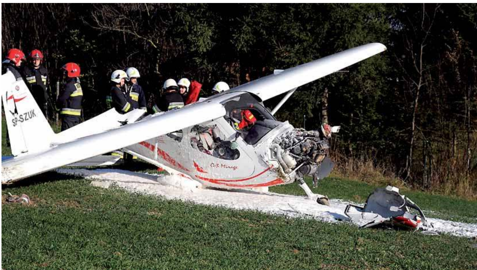
Samolot ma rozbity przednią część kadłuba, uszkodzone skrzydła i połamane belkę ogonową.
