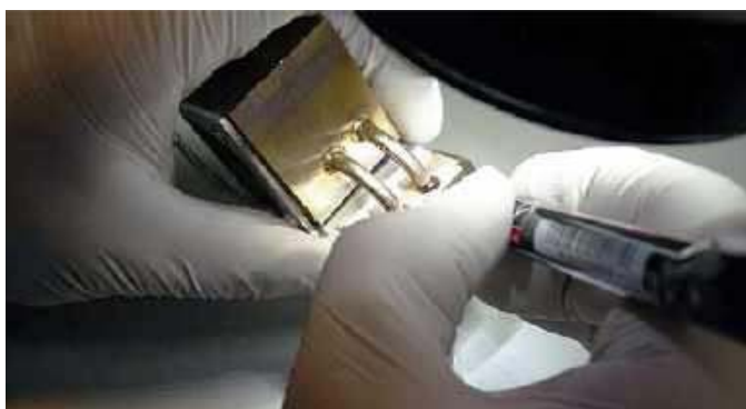
Fotografia 20. Montaż bloku chłodzącego modułu z fotografii 19 ( http://t.ly/lcAEw )
