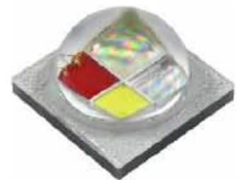
Fotografia 7. Dioda LED RGBW dużej mocy z serii XLamp® XM-L® Color Gen 2 ( http://t.ly/DdjHO )
