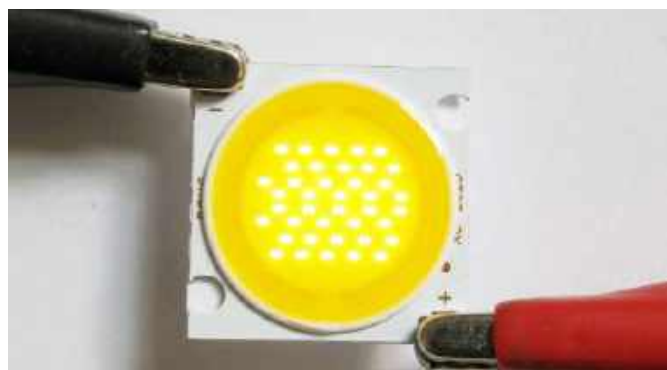
Fotografia 3. Moduł COB zasilany niskim napięciem – jak na dłoni widać poszczególne chipy LED (za: http://t.ly/rX2ka )
