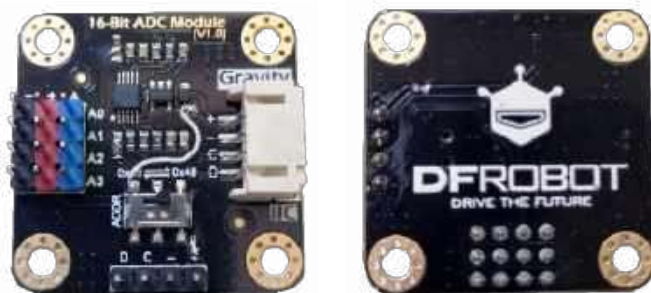
Fotografia 2. Zmodyfikowana płytka drukowana modułu I 2 C ADS1115: a) przód, b) tył
