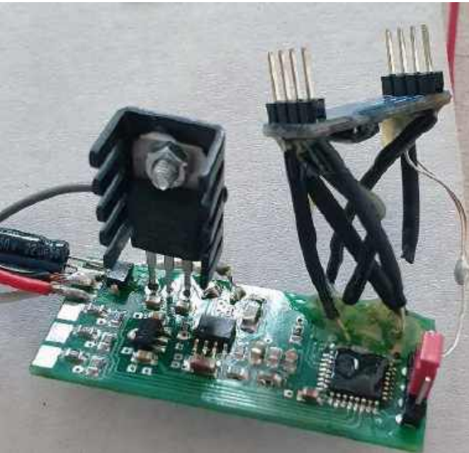
Fotografia 2. Układ prototypowy po pomyleniu rozmiaru obudowy jednego z układów scalonych
