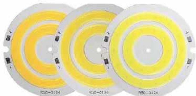
Fotografia 5. Nietypowe, chińskie moduły COB (za: http://t.ly/lqxy5 )
