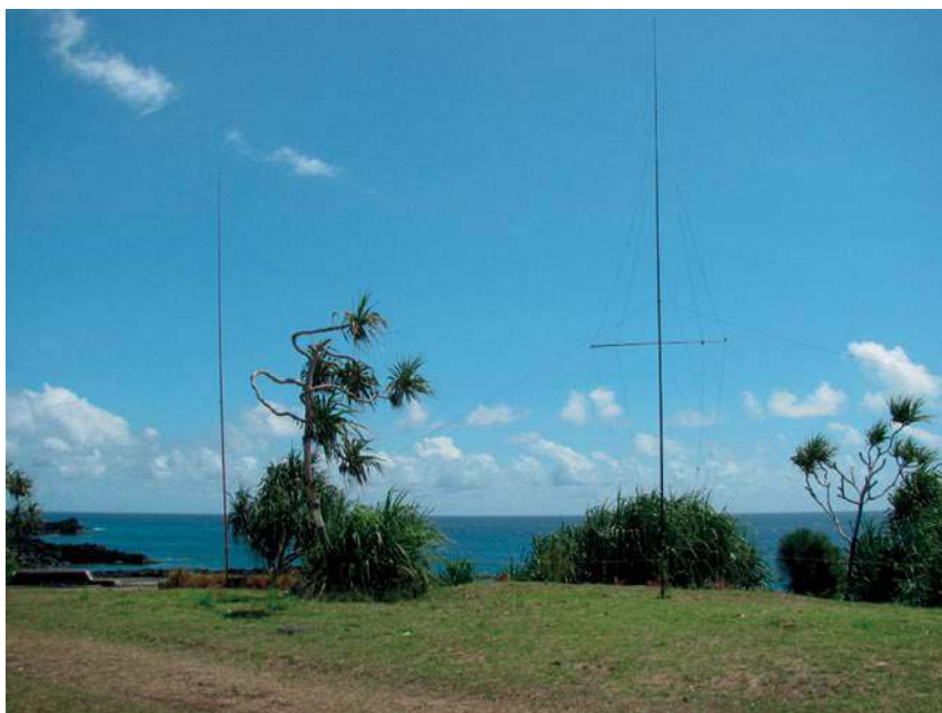
ANTENY D60AD: PO PRAWEJ VDA NA 17 I 12 M WRAZ Z WIBRATOREM NA 40 M, PO LEWEJ REFLEKTOR NA 40 M
