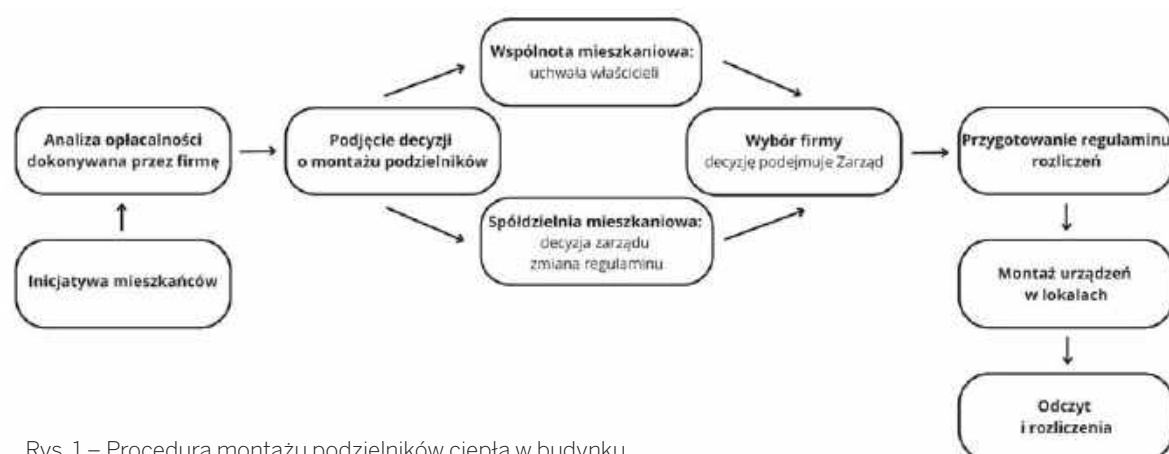
Rys. 1 – Procedura montażu podzielników ciepła w budynku.
