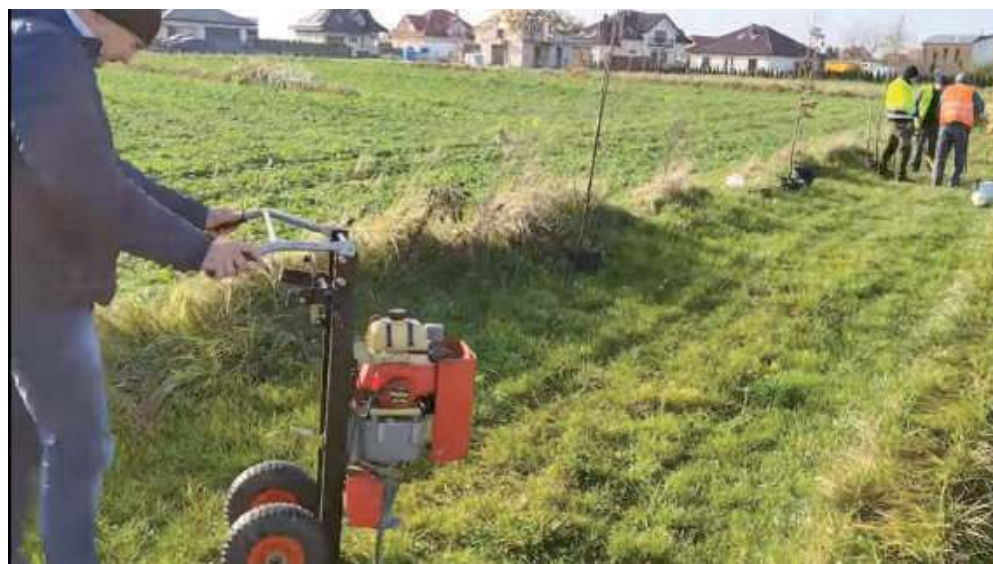
Przy sadzeniu 85 grabów wzdłuż ulicy Kardynała Wyszyńskiego używana jest maszyna, która rozluźnia ziemię przy pomocy sprężonego powietrza. Pomaga to w pracy, ale również polepsza rozwój systemu korzeniowego drzew - informuje UM w Łęcznej.
