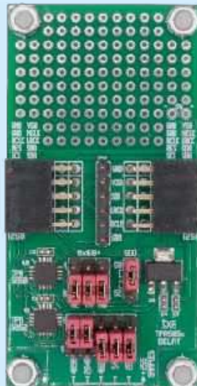
Fotografia 7. Zmontowany moduł DSP1701A_TPA505x
