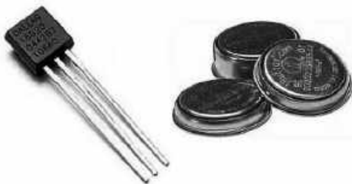
Fotografia 1. Układy z interfejsem 1-Wire: czujnik temperatury DS18B20 (w obudowie TO-92) i układy „pastylkowe” do bezpiecznego uwierzytelniania typu DS1990, tzw. iButton ( https://t.ly/Ggkq8 )
