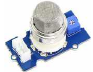
Fotografia 2. Moduł Grove – Gas Sensor(MQ2) firmy SeedStudio [5]
