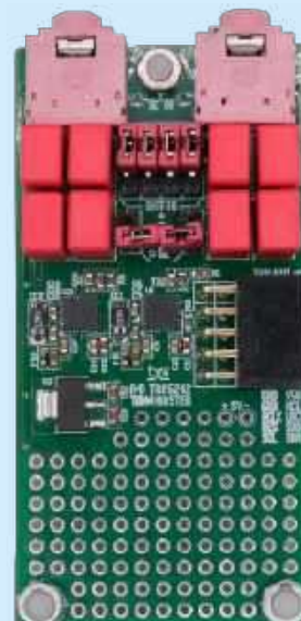
Fotografia 2. Zmontowany moduł DSP1701A_ADCTDM_TAA5242
