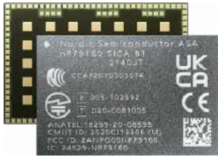
Fotografia 5. Moduł SiP nRF9160 marki Nordic Semiconductor ( https://t.ly/VQfdv )
