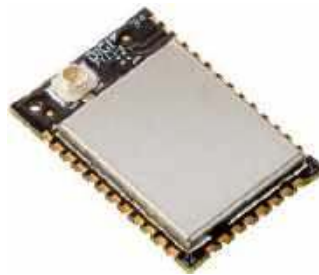
Fotografia 8. Podstawowa wersja modułu Digi Xbee 3 (https://t.ly/wqugm)
