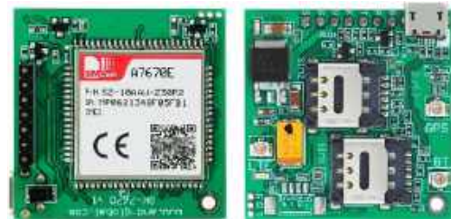
Fotografia 1. Płytki BK-A7670 firmy AND Technologies zawiera wszystkie potrzebne komponenty do pracy modułu SIMCOM A7670E, dzięki którym można łączyć się z siecią GSM 4G/LTE. Zdjęcie pochodzi ze strony dystrybutora
