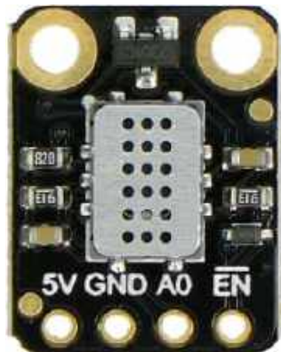
Fotografia 5. Moduł detektora wielogazowego MEMS (SEN0440) [7]
