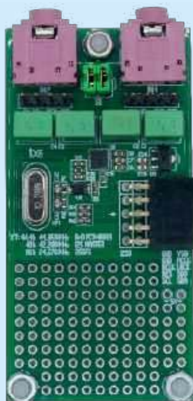
Fotografia 1. Zmontowany moduł DSP1701A_AD_PCM1809
