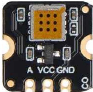
Fotografia 7. Moduł detektora tlenku węgla MEMS (SEN0564) [9]
