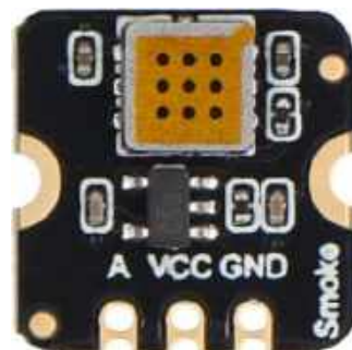
Fotografia 6. Moduł detektora dymu MEMS (SEN0570) [8]
