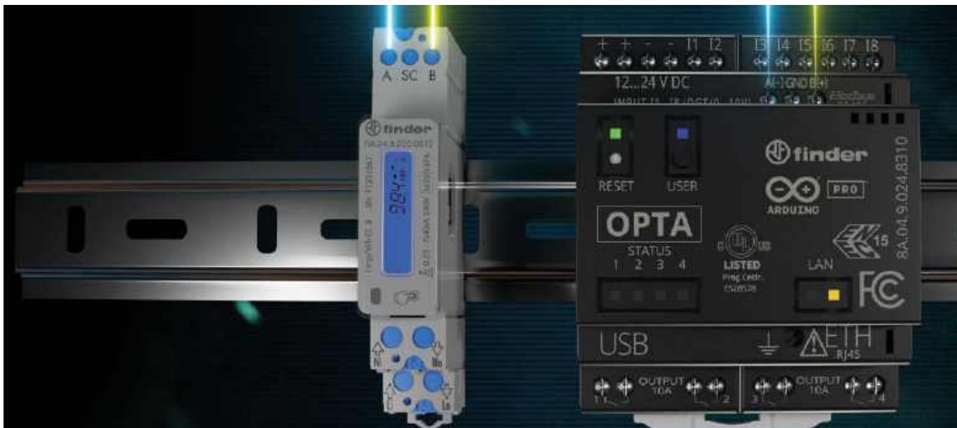
Fotografia 1. Połączenie sterownika OPTA z licznikiem serii 7M pozwala na zaawansowaną analizę zużycia energii, a także gromadzenie potrzebnych danych w chmurze
