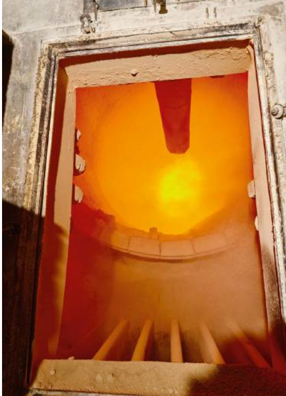
Obrotowy piec wapienny – komora spalania w fabryce węgla wapnia
