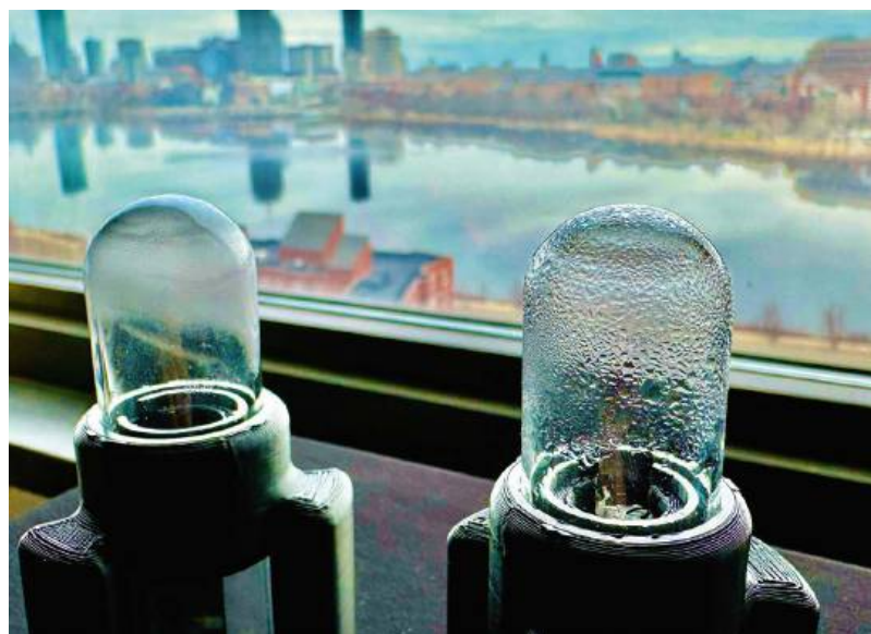
„Wytrząsanie” wody z powietrza przy pomocy ultradźwięków
