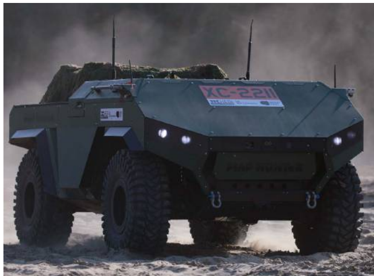
Polski PIAP HUNTeR waży niemal 4 t i występuje w kilku wersjach, w tym jako pojazd rozpoznania, transportowy lub wsparcia ogniowego.
