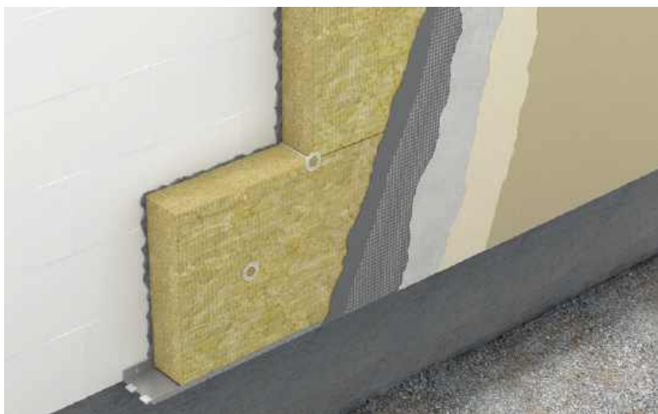
System termoizolacji ścian metodą ETICS polega na przyklejeniu do muru wełny lub styropianu, zabezpieczeniu ich warstwą kleju z siatką zbrojącą i otynkowaniu. ROCKWOOL
