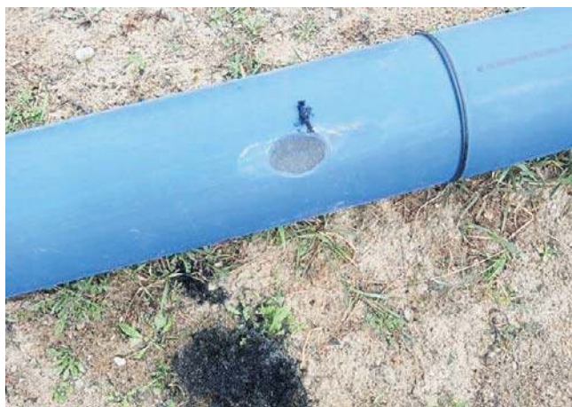
Uszkodzona rura przygotowana do montażu na odcinku budowy wodociągu Steżycza Huta - Steżycza
