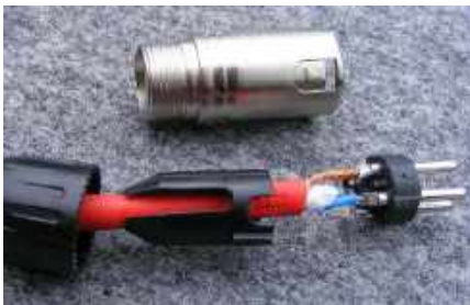
Rysunek 7. W przypadku wtyków Neutrik XLR obudowa jest zakładana po lutowaniu. Tylko tuleja zaciskowa kabla musi być najpierw założona na przewód. Zespół zacisku zaciska się na kablu za pomocą szczeliny. Nie ma śrub, więc montaż jest szybki
