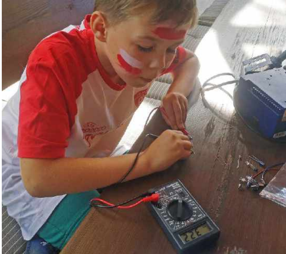
Fotografia 1. Użycie multimetru z ustawioną funkcją omomierza w celu odnalezienia rezystorów o określonych w spisie elementów wartościach, celem zamontowania ich na właściwych pozycjach na płytce drukowanej. Na zdjęciu Tymek, koło zainteresowań Młodych Entuzjastów Elektroniki, Wrocław
