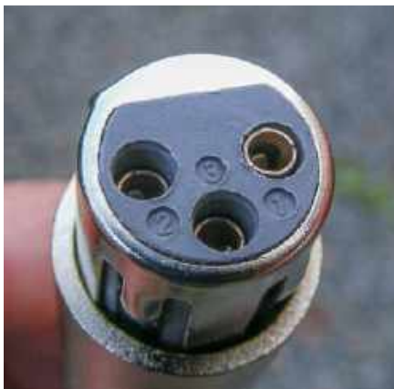
Rysunek 4. Uziemienie złącza XLR (prawy górny róg) zawsze podłącza się jako pierwsze, ponieważ jest nieco dłuższe niż pozostałe – co za wspinały pomysły!
