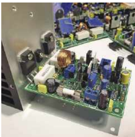
Wzmacniacz można łatwo zamontować na radiatorze 75 mm, jak pokazano powyżej. Brakuje rezystorów ochronnych SOA, ponieważ planowane było porównanie osiągnięć wzmacniacza z nimi i bez nich. Następnie można je zamontować obok siebie, tworząc większy system, na przykład tworząc konfigurację sześciokanałową przedstawioną obok. Zestaw ten został zamontowany w obudowie typu rack 2U
