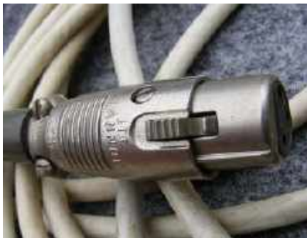
Rysunek 5. Oryginalne i wciąż najlepsze złącza XLR firmy Cannon. Zwróć uwagę na gumową wkładkę na złączu żeńskim
