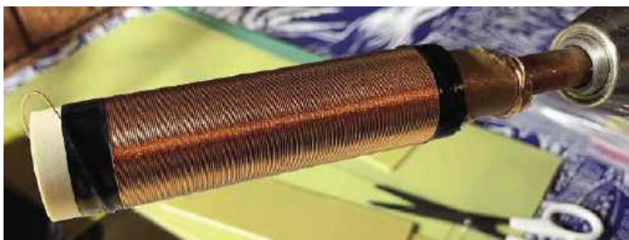
Cewka wtórna została nawinięta przy pomocy wiertarki ręcznej, ale można to zrobić ręcznie
