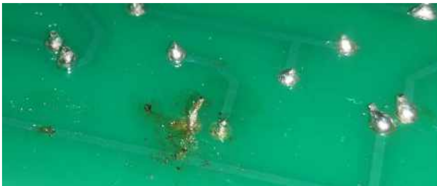
Fotografia 13. W środkowej części zdjęcia znajduje się element przewleczony przez otwory, wokół których brak jest pierścienia miedzi (zerwane pady)
