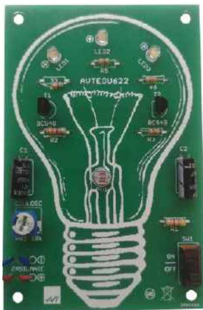
Fotografia 11. Zmontowany układ, widok od strony komponentów
