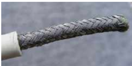
Rysunek 14. Odizolowany kabel odstaniający opłot ekranu
