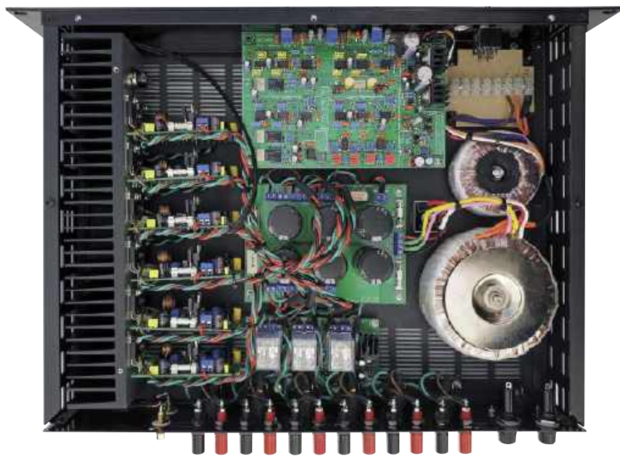
Wzmacniacz można łatwo zamontować na radiatorze 75 mm, jak pokazano powyżej. Brakuje rezystorów ochronnych SOA, ponieważ planowane było porównanie osiągnięć wzmacniacza z nimi i bez nich. Następnie można je zamontować obok siebie, tworząc większy system, na przykład tworząc konfigurację sześciokanałową przedstawioną obok. Zestaw ten został zamontowany w obudowie typu rack 2U
