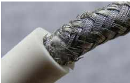
Rysunek 15. Uszkodzony opłot z powodu nieostrożnego zdejmowania izolacji
