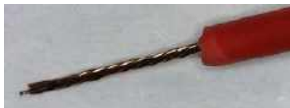
Fotografia 8. Obszar odstosowanej izolacji, po skręceniu wielu bardzo cienkich drucików
