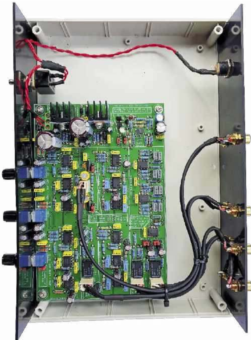
Chociaż aktywna zwrotnica nie musi mieć własnej obudowy, można ją umieścić w sposób pokazany powyżej. W przedstawionym przykładzie wykorzystano obudowę Altronics H0480F o szerokości 200 mm, głębokości 155 mm i wysokości 65 mm. Do zasilania użyto zasilacza 12 V AC (Altronics M9267A), ale wersja 0,5 A będzie również działała prawidłowo
