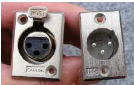
Rysunek 2. Złącza XLR do montażu na panelu/obudowie: wyjścia są zawsze męskie (ze stykami), a wejścia żeńskie (z otworami)
