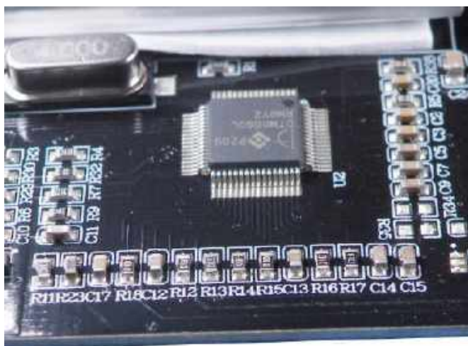
5. Elementy wokół układu DTM0660L (© 2023 Jos Verstraten)
