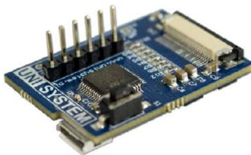
Fotografia 13. Unisystem EPD-COMPACT-DEMO-DH – platforma testowa do wyświetlaczy EPD
