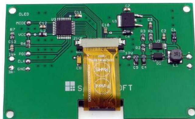
Fotografia 1. Zmontowany obwód drukowany widziany od strony BOTTOM
