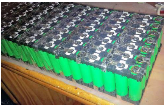
Fotografia 3. Gotowy zlutowany pakiet ogniw
