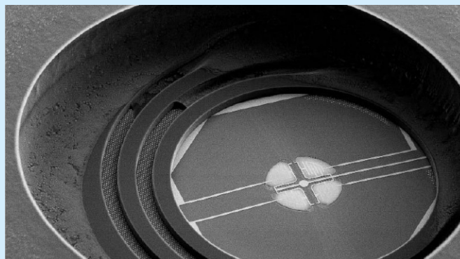
Rysunek 3. Widok budowy wewnętrznej czujnika SGP30 firmy Sensirion [7]
