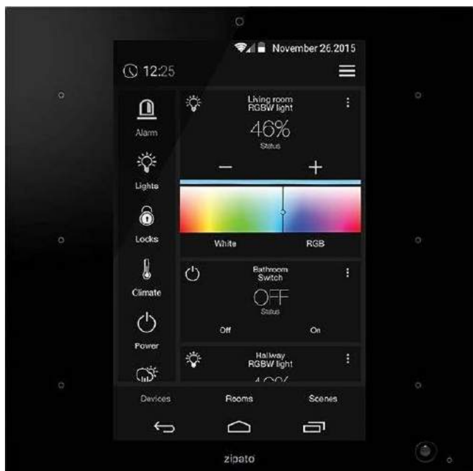
Fotografia 11. Panel sterujący i centralka do systemu smart home
