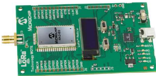
Fotografia 2. Zestaw ewaluacyjny i gotowe urządzenie sieci LoRaWAN klasy A, zbudowane na bazie modemu LoRa RN2483
