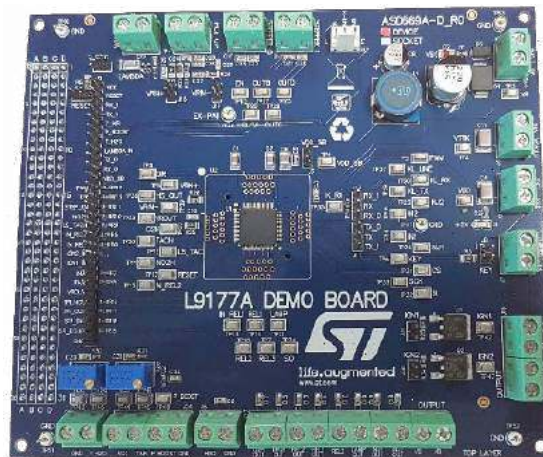
Fotografia 6. EVAL-L9177A płytkę ewaluacyjną z inteligentnym układem zasilania L9177A
