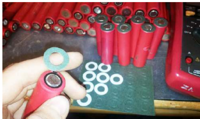
Fotografia 1. Przyklejanie izolatorów do ogniw
