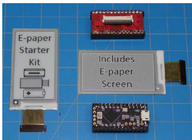
Fotografia 14. Pervasive Displays Teensy – zestaw startowy ułatwiający integrację tanich i energooszczędnych wyświetlaczy E-paper.
