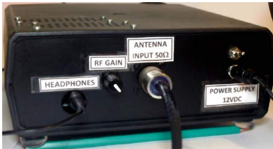
Fotografia 5. Aranżacja i opis tylnego panelu odbiornika
