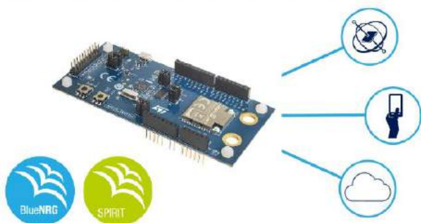
Fotografia 8. Zestaw do dwuzakresowej komunikacji bezprzewodowej Bluetooth Low Energy (BLE) oraz na pasmo Sub-1GHz o nazwie STEVAL-FKI001V1
