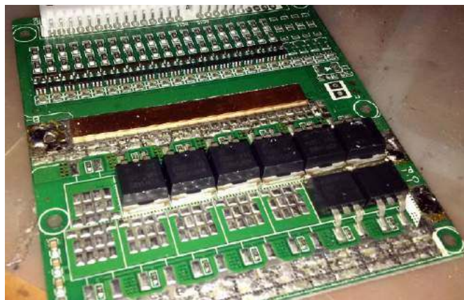
Fotografia 5. Wygląd płytki modułu BMS
