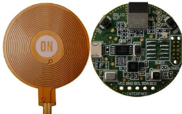
Fotografia 15. Zestaw deweloperski RSL10 Sensor Development Kit, ułatwiający projektowanie energooszczędnych aplikacji IoT
