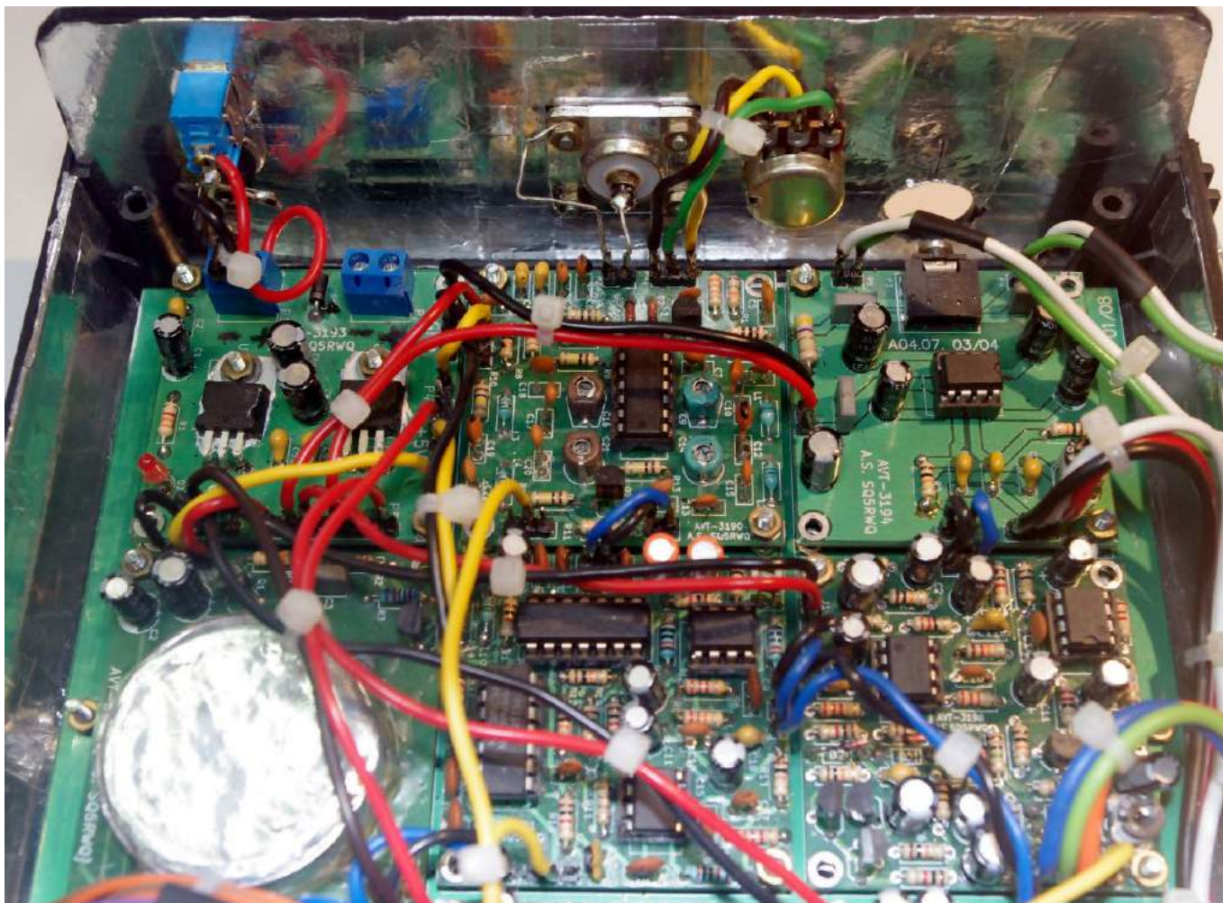
Fotografia 4. Wnętrze zmontowanego odbiornika - widok tylnej części
