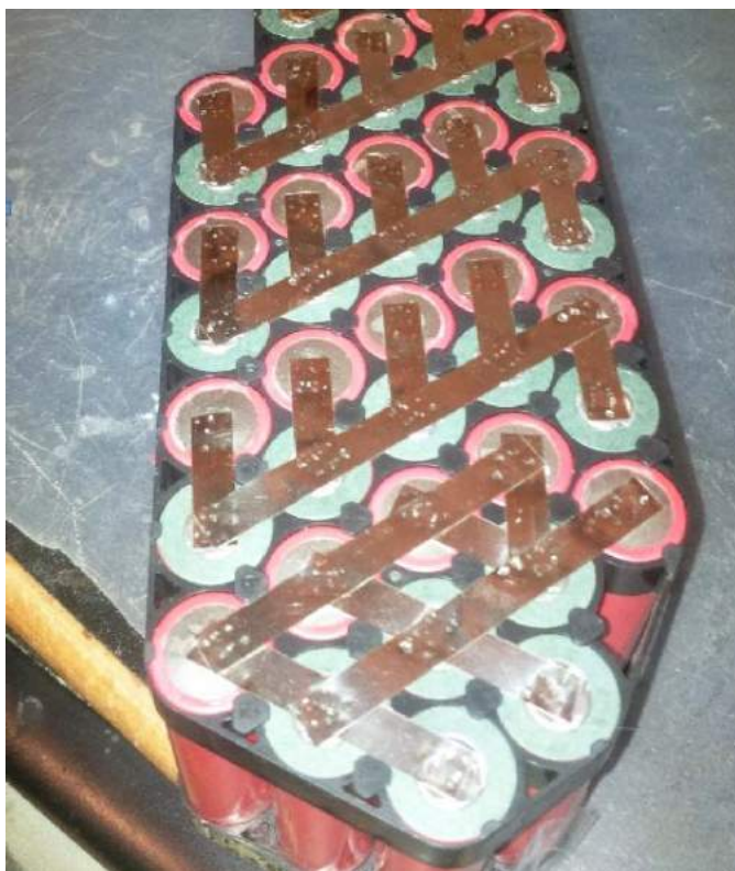
Fotografia 4. Gotowy zgrzany pakiet ogniw
