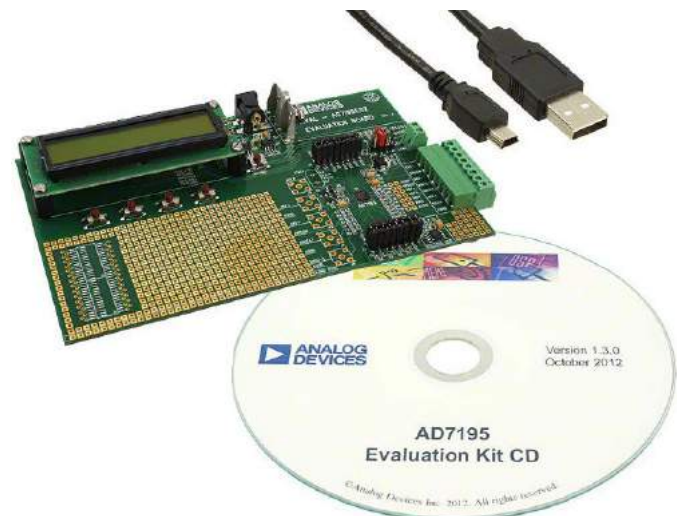
Fotografia 4. Płytkę Analog Devices EVAL-AD7195EBZ z ultraniskoszumowym, 24-bitowym przetwornikiem ADC
