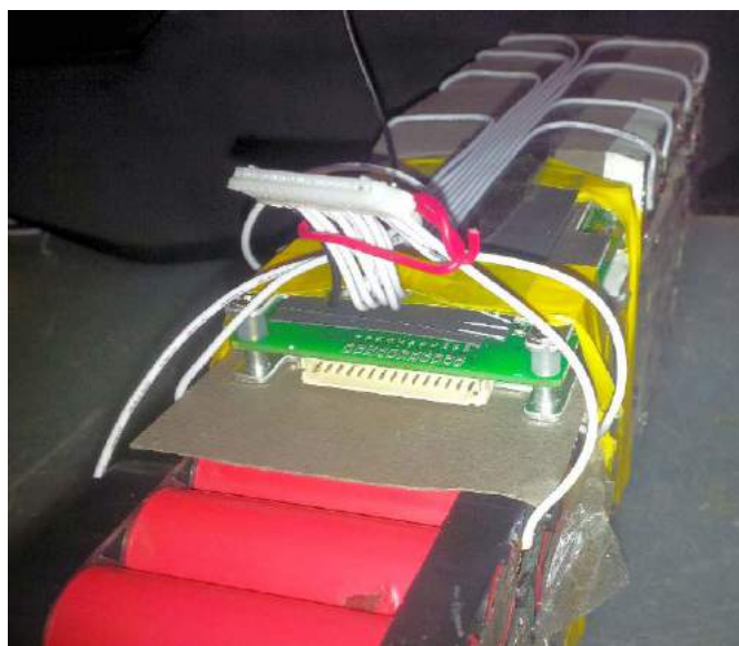
Fotografia 6. Wszystkie kable balansera przylutowane i zamocowane
