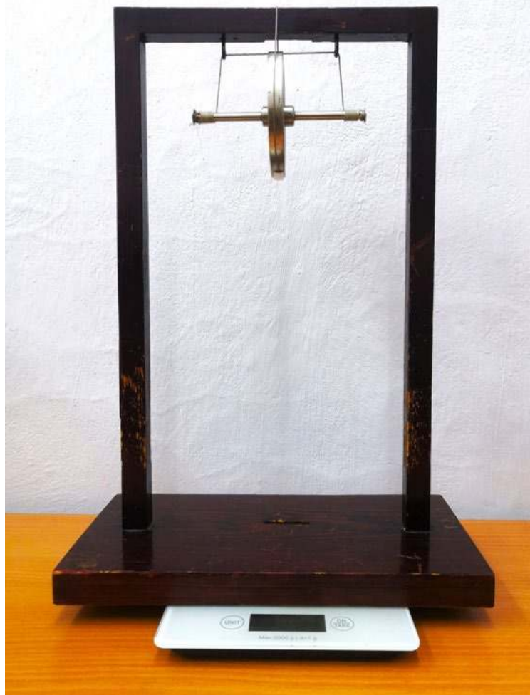
Fot. 1. Jedno z kół Maxwella używane do doświadczeń ustawione na elektronicznej wadze kuchennej.
