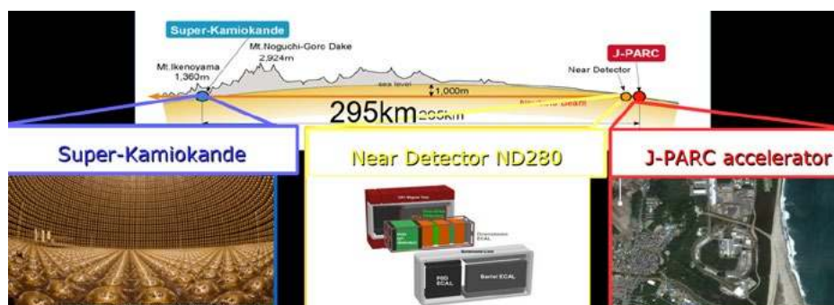
Rysunek 7. Schemat przedstawiający eksperyment T2K. W górnym rysunku zaznaczony jest schemat wiązki. Dolne zdjęcia przedstawiają od prawej: akcelerator w laboratorium JPARC służący do produkcji wiązki neutrino, stację bliskich detektorów służącą do pomiaru typów oddziaływań neutrino i spektrum wiązki blisko punktu produkcji, daleki detektor Super-Kamiokande służący do badania oscylacji neutrino.
