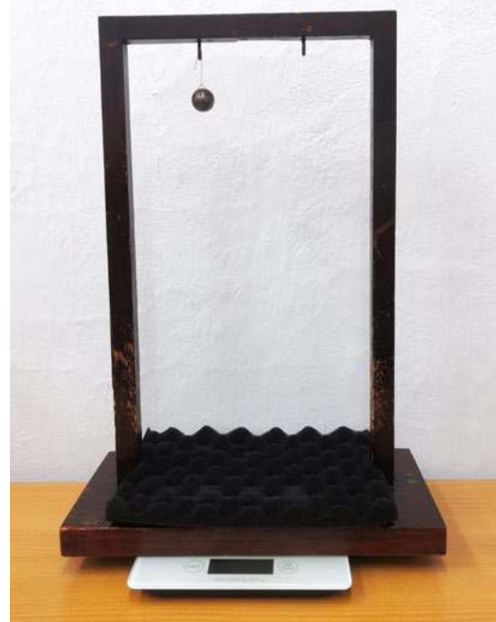
Fot. 2. Przykład układu doświadczenia do wykazania stanu nieważkości spadającej kulki.
