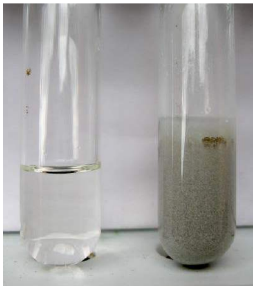
4. W bezbarwnym roztworze soli bizmutu (z lewej) pod wpływem soli cyny(II) powstaje szary osad metalicznego bizmutu (z prawej)
