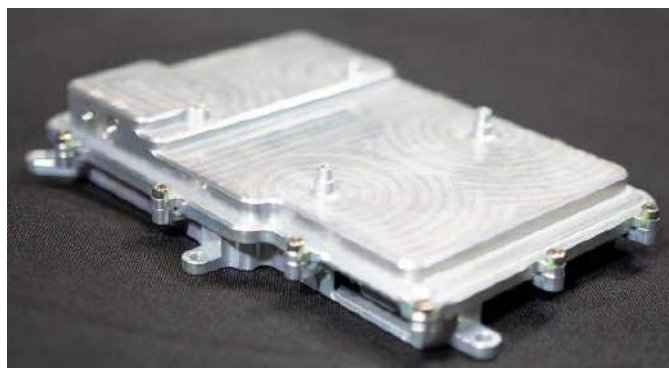
Fotografia 38. Miniaturowy moduł telekomunikacyjny SDR marki Rocket Lab USA, wykonany w customowej obudowie z frezowanego aluminium (w podłużnym wycięciu widoczne złącze, prawdopodobnie w standardzie D-Sub Nano). Źródło: https://t.ly/ovTv
