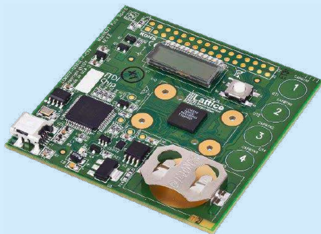
Fotografia 2. Płytki prototypowa MachXO2 Pico Board
