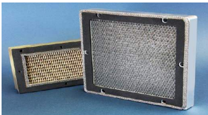
Fotografia 20. Duże osłony EMI przeznaczone do ochrony otworów wentylacyjnych oraz wycięć obudowy dla wentylatorów. Widoczne są uszczelki dwufunkcyjne (pełnią rolę dodatkowego uszczelnienia EMI oraz chronią przed zasysaniem pyłu i kurzu). Źródło: https://t.ly/C68Q
