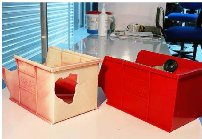
Fotografia 8. Porównanie stanu dwóch tworzywowch pojemników (wyprodukowanych 15 lat przed wykonaniem fotografii): po lewej – pojemnik wystawiony na działanie światła słonecznego, po prawej – przedmiot przechowywany przez ten czas z dala od bezpośredniej ekspozycji na światło słoneczne ( https://bit.ly/3s2yi9l )
