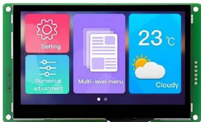
Fotografia 4. Moduł HMI typu DWIN DMG48270C043
