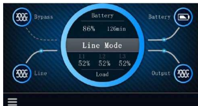
Rysunek 2. Dotykowy wyświetlacz dostępny w modelach trójfazowych
