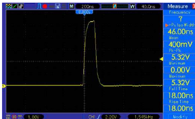
Rysunek 2. Oscylogram impulsu napięcia wyjściowego
