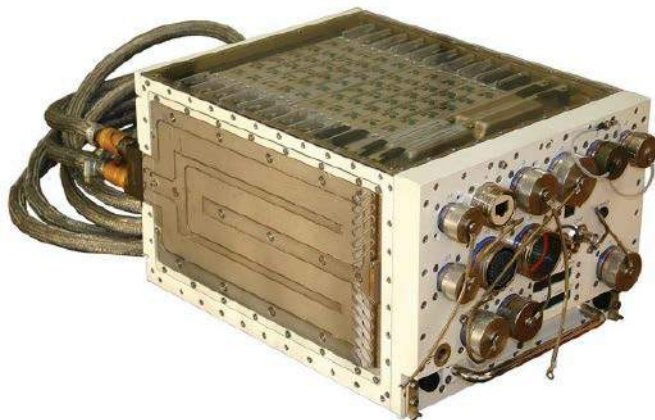
Fotografia 37. Obudowa osprzętu ATR z chłodzeniem wodnym umieszczonym w ścianach bocznych ( https://t.ly/ZzDi )
