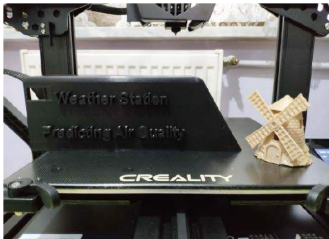
Fotografia 1. Wydrukowana obudowa i ozdabiający nią model wiatraka
