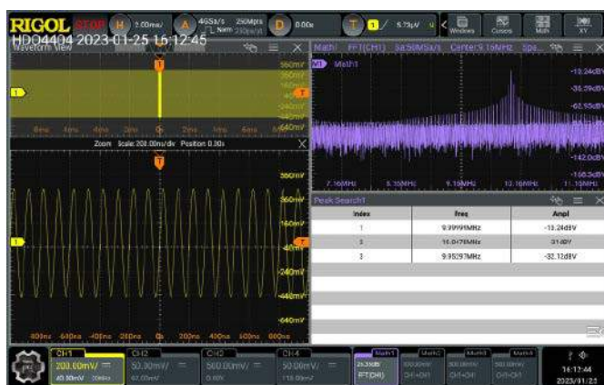
Rysunek 2. Oscyloskop dość dobrze radzi sobie z obsługą wielu okien jednocześnie, choć – paradoksalnie – największy wpływ na pogorszenie responsywności GUI mają... tabele (a nie wykresy, aktualizowane w czasie rzeczywistym)
