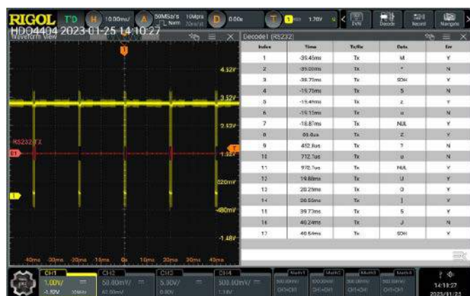
Rysunek 5. Wielokrotne próby zdekodowania sygnału UART spętły na niczym
