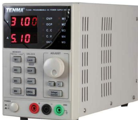
Fotografia 6. Zasilacz laboratoryjny programowalny, 1 wyjście 0...30 V, 0...5 A ( https://bit.ly/3KdcRMQ )
