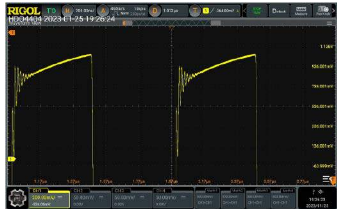
Rysunek 10. Zniekształcenie sygnału prostokątnego o amplitudzie 2 Vpp przy wzmocnieniu na poziomie 200 mV/div
