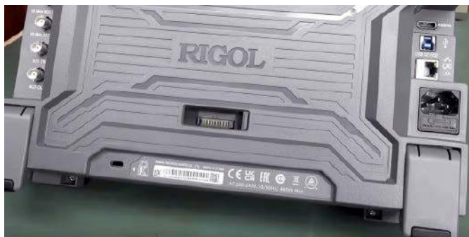
Fotografia 5. Wygląd złącza opcjonalnego akumulatora po odstąpieniu zaślepki ( https://t.ly/7mv3 )
