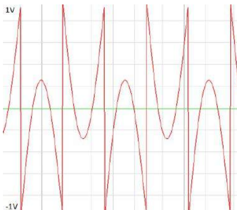
Rysunek 3. Odpowiedź filtra środkowozaporowego na pobudzenie falą prostokątną o częstotliwości równej częstotliwości rezonansowej filtra f=f_0=100 Hz, częstotliwość próbkowania f_p=10 kHz, U_{we}=1 V, Q=10
