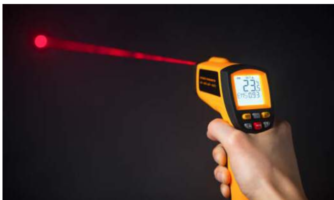
Fotografia 13. Pirometr z funkcją manualnego ustawiania emisyjności badanej powierzchni ( https://t.ly/JOEO )
