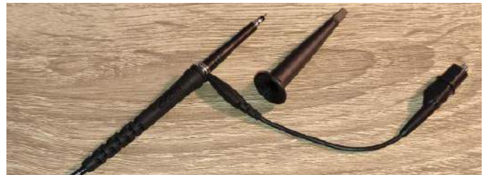
Fotografia 13. Sonda oscyloskopowa typu RP3500A
