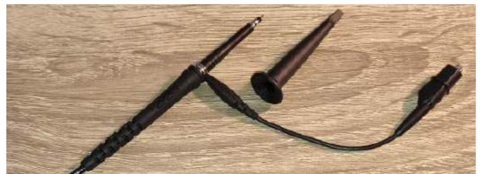
Fotografia 13. Sonda oscyloskopowa typu RP3500A
