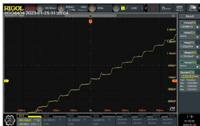
Rysunek 12. Sygnał z rysunku 11 podczas akwizycji w trybie uśredniania
