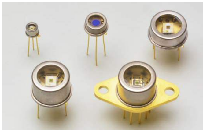
Fotografia 7. Fotodiody z serii G12183 marki Hamamatsu ( https://t.ly/rpYt )
