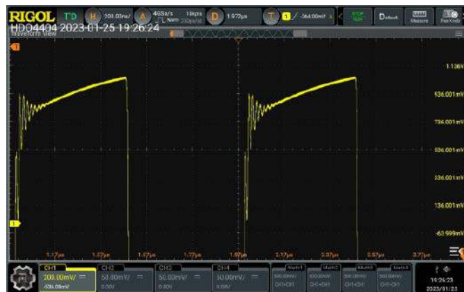
Rysunek 10. Zniekształcenie sygnału prostokątnego o amplitudzie 2 Vpp przy wzmocnieniu na poziomie 200 mV/div
