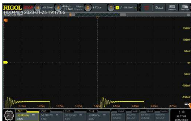
Rysunek 9. Obraz sygnału z rysunku 8 po zwiększeniu wzmocnienia do 50 mV/div (reszta ustawień bez zmian)
