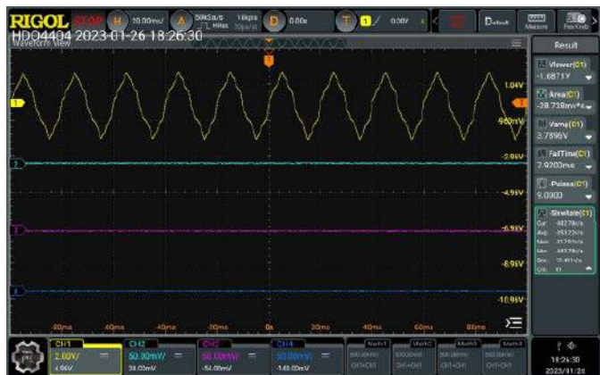
Rysunek 1. Podstawowy wygląd ekranu oscyloskopu DH04404
