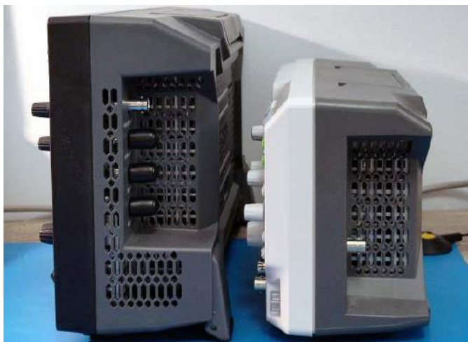
Fotografia 3 Porównanie głębokości obudowy oscyloskopów z serii DHO4000 i DS1000Z
