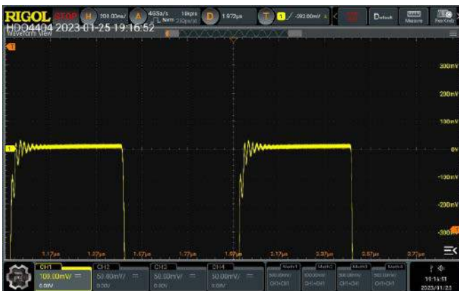
Rysunek 8. Przebieg z rysunku 7 przesunięty za pomocą biasu, ustawionego na wartość równą -500\text{ mV} , a następnie powiększony do 100\text{ mV/div}
