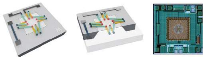
Rysunek 9. Schematyczne przedstawienie budowy czujnika pirometrycznego na bazie termostosu, wykonanego w technologii MEMS. Po prawej – rzeczywisty wygląd struktury ( https://t.ly/vyw8 )
