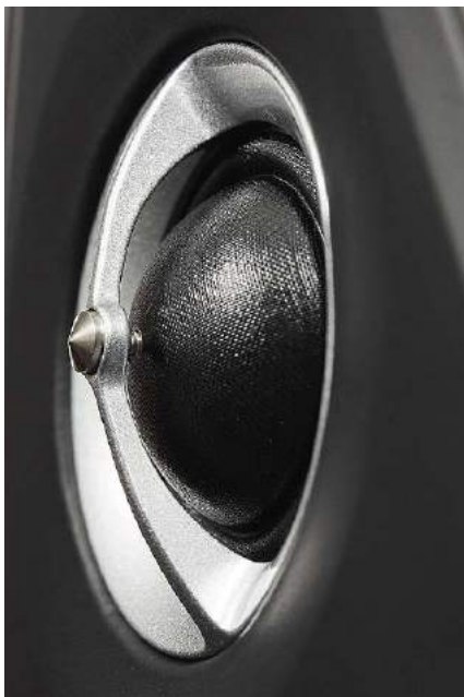
Szczyt jedwabnej kopułki dotyka (i unieruchamia) malutki stożek umieszczony w środku łuku – to jego podstawowa rola.
