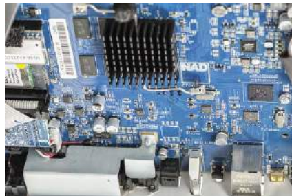
Na górnym piętrze rozłożył się przedwzmacniacz, tutaj panoszą się sygnały cyfrowe.
