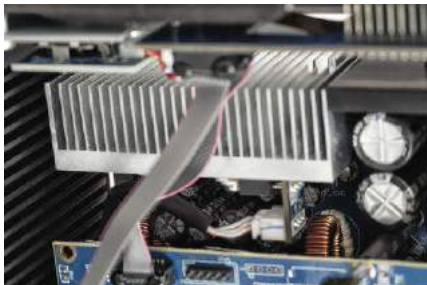
Na dolnym piętrze ulokowano impulsowy zasilacz oraz końcówki mocy – moduły Hypexa.
