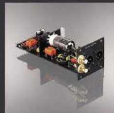
OUT3 DD XLR Wyjście z buforem lampowym, umożliwiające również sterowanie końcówkami mocy
