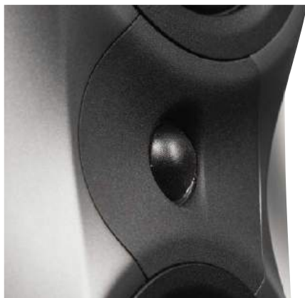
Sama kopułka jest wciąż podobna do pierwowzoru: jedwabna o średnicy 28 mm, ale wszystko wokół niej jest już zupełnie inne.
