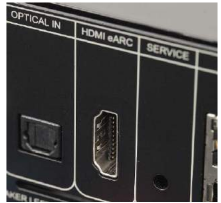
Do systemów Hi-Fi coraz częściej podłączamy telewizor, C700 ma na to nawet kilka sposobów, a najlepszym jest HDMI z kanałem eARC.
