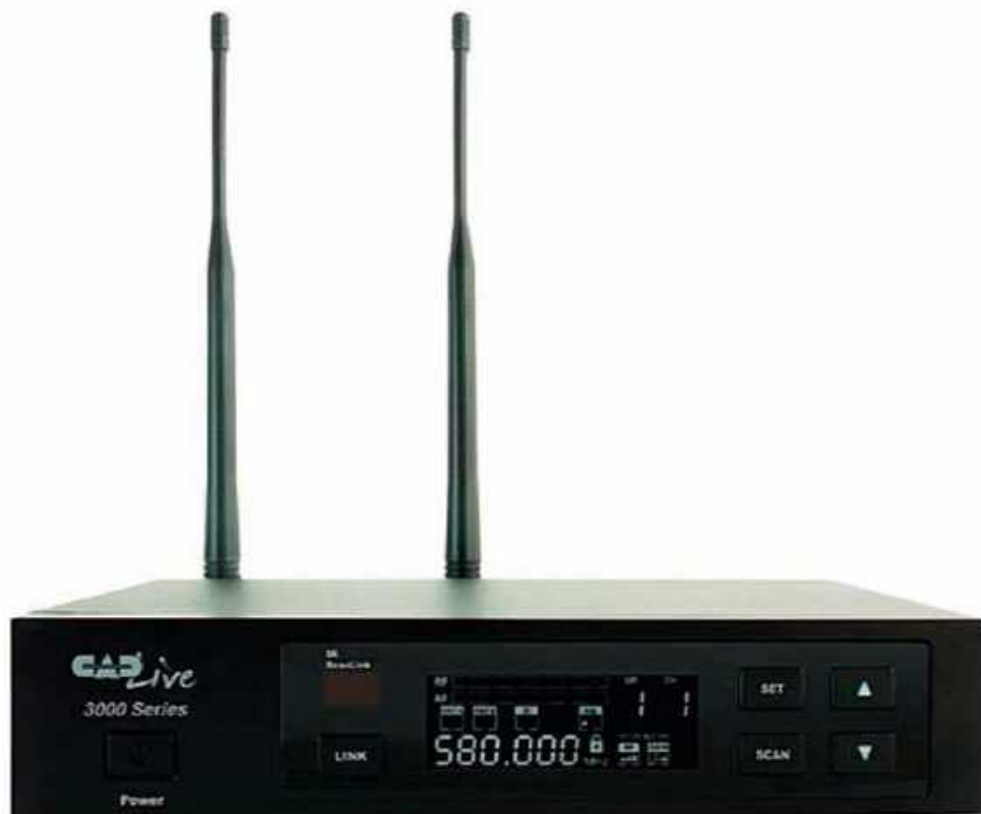
Odbiornik zamknięty jest w metalowej obudowie o szerokości połowy racka.
