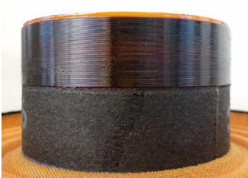
Spalona cewka zachowała swoją strukturę mechaniczną.
