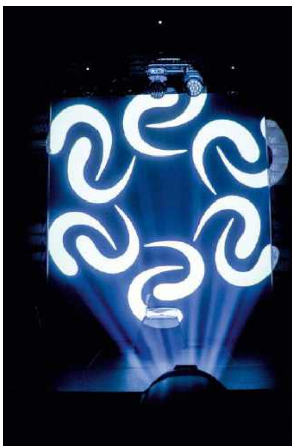
Robe T1 Profile dysponuje tarczą z 7 obrotowymi gobosami, kilka z nich jest dobrze znanych z innych urządzeń firmy Robe.
