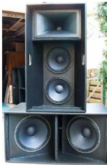
Tubowy zestaw 2 x 12" z obudową z otworem i subwoofer 2x15".
