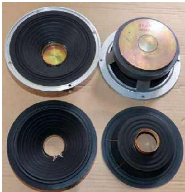
Głośnik 6.5" z zawieszeniem CE i membrana z zawieszeniem PE.
