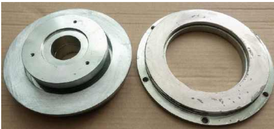
Rozklejony obwód, po usunięciu śladów spoiwa z nabiegunnika i magnesu.
