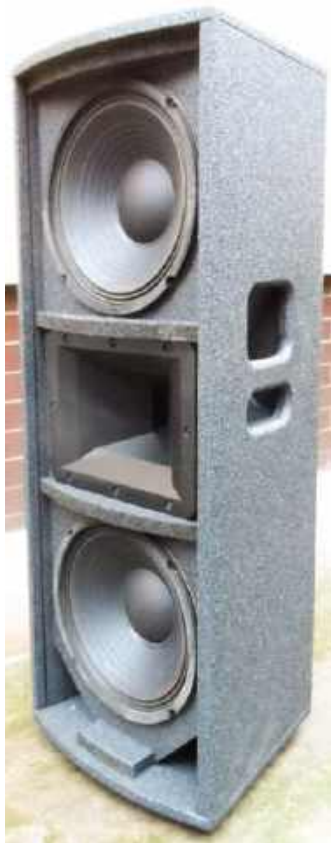
Głośniki 10" w zestawie średnio-wysokotonowym.
