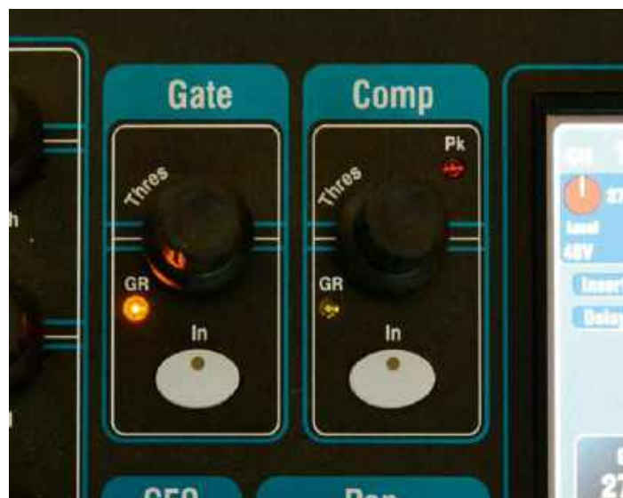
Bramki, podobnie jak kompresory, to obecnie standardowe wyposażenie WSZYSTKICH kanałów mikserów cyfrowych, również tych „entry level”.
