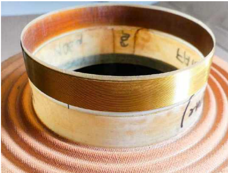
Pozornie nieuszkodzony głośnik wymagał jednak wymiany kompletu naprawczego.
