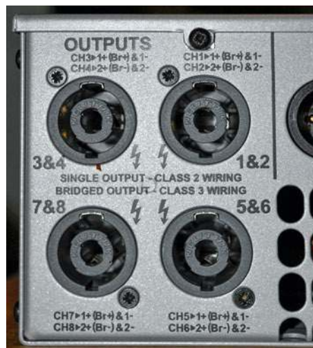
Sygnały do głośników dostarczane są parami, za pośrednictwem 4 gniazd Speakon NL4 – para wyjść 1 i 2 pierwszym gniazdem, para 3 i 4 drugim itd.
