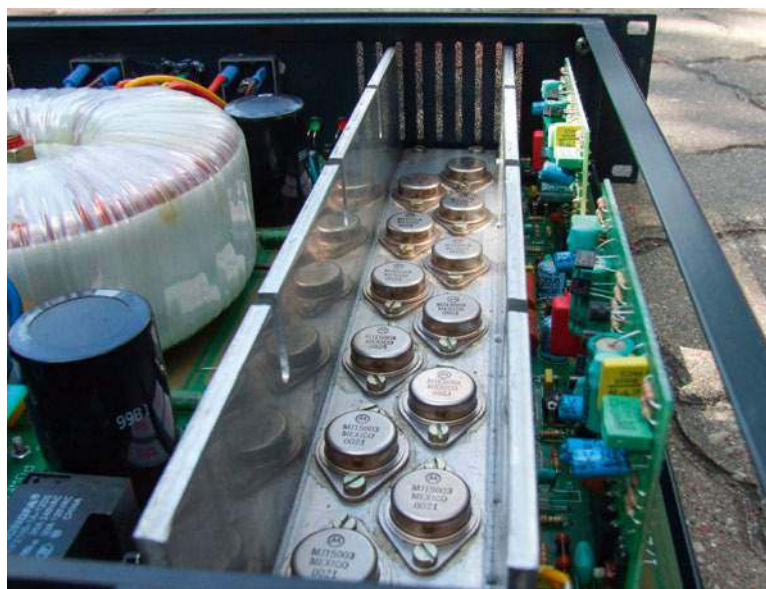
Końcówki mocy PMP wyposażane były w bardzo popularne w swoim czasie tranzystory mocy w obudowach TO3, stosowane również przez wielu producentów zachodnich.
