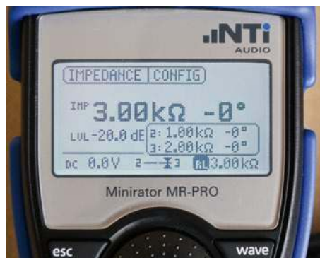
Funkcja pomiaru impedancji MR-PRO nie tylko pozwala zmierzyć impedancję (moduł i fazę), ale również wartość napięcia Phantom oraz zbadać symetrię złącza.
