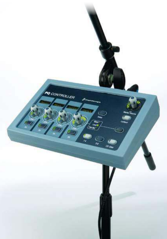
Zdalne sterowanie zapewniały osobiste sterowniki Personal Q (PQ), których można było wykorzystać maksymalnie 8.
