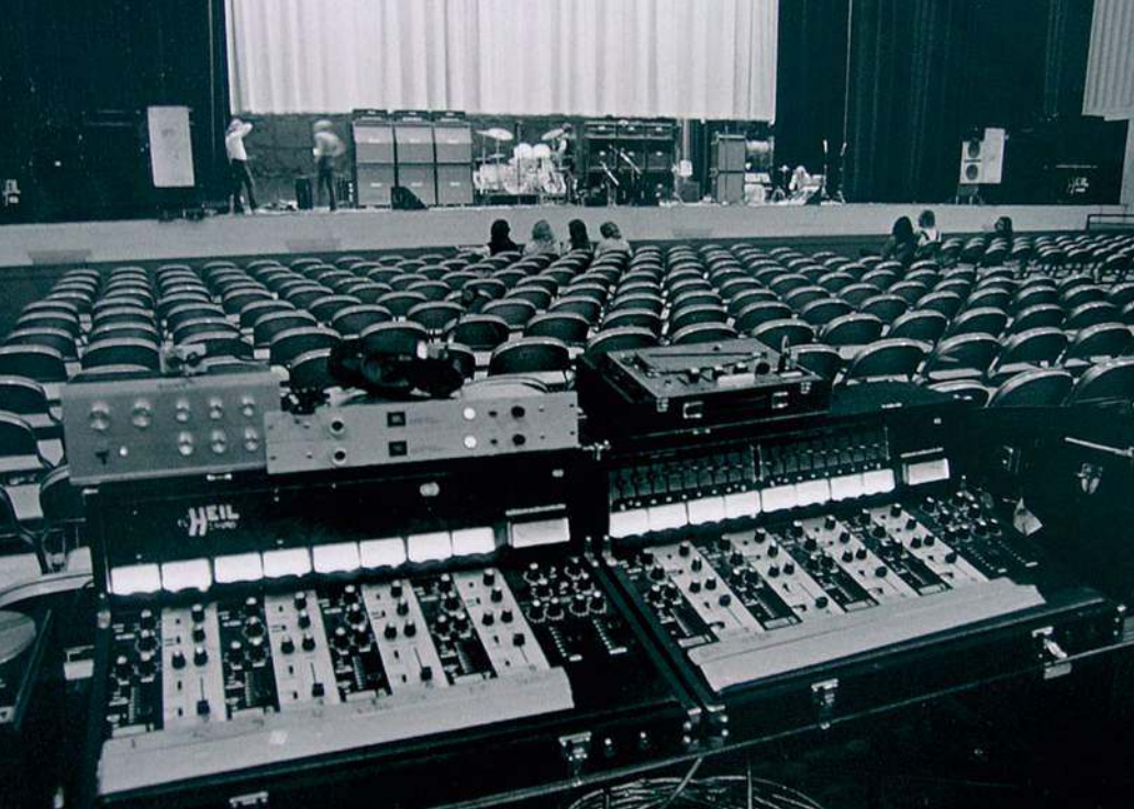
Konsoleta mikserska zbudowana w kooperacji Heila z firmą Sunn, wykorzystywana również do realizacji odsłuchów.
