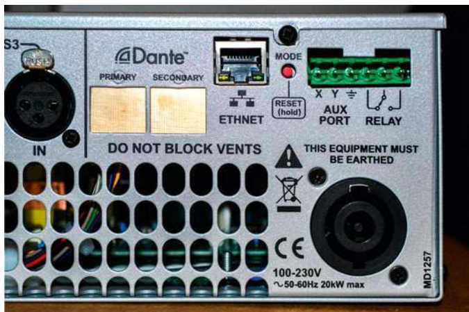
Wzmacniacz zasilany jest z 32-amperowego gniazda PowerCON.
