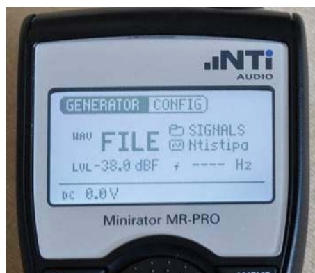
Dostęp do pamięci wewnętrznej (FILE) MR-PRO pozwala na zapisywanie, a następnie odtwarzanie dowolnych sygnałów w formacie „wav”.
