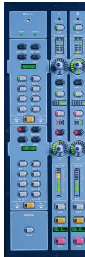
Panel wyboru enkoderów oraz dwie pierwsze sekcje (kanały) wejściowe w mikserze VENUE D-Show.
