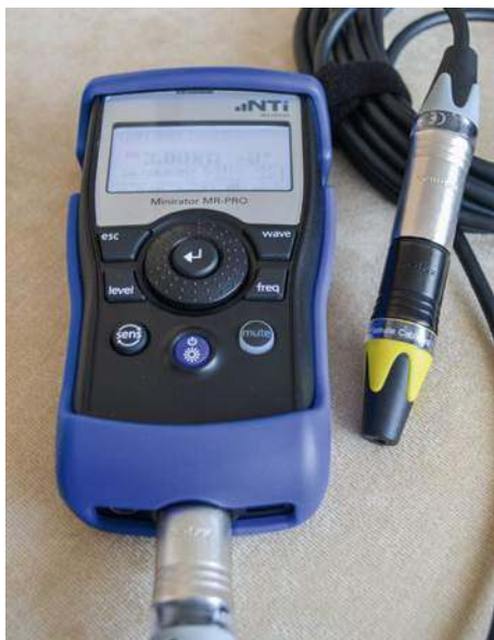
W przypadku testowania kabli, do których jednoczesny dostęp z dwóch stron jest utrudniony (np. zainstalowanych na stałe w przepustach), z pomocą przychodzi Cable Test Adapter.
