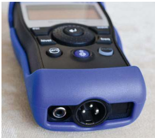
Minirator MR-PRO wyposażony jest w gniazda wyjściowe XLR i RCA (na dole urządzenia)...
