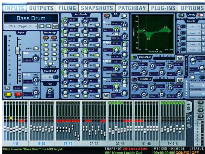
Okno wybranego kanału wejściowego wraz z tłumikami i wskaźnikami w oprogramowaniu VENUE.
