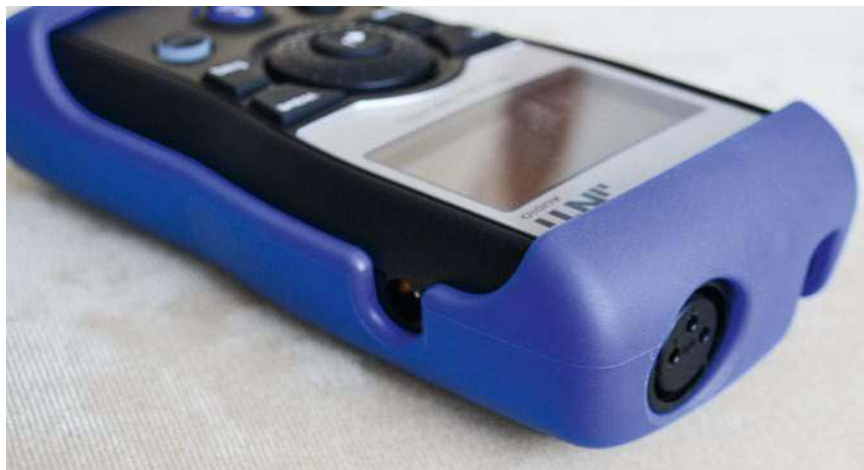
... oraz gniazdo wejściowe XLR (na górze), wykorzystywane przy testowaniu kabli.
