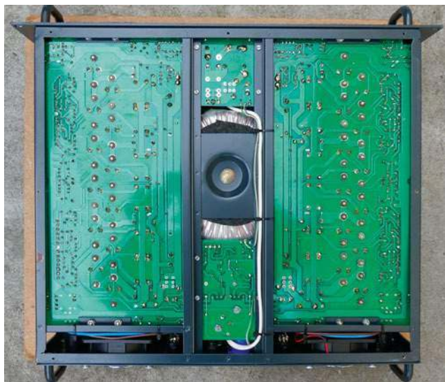
Końcówki mocy PMP wyposażane były w obudowę typu „klatka”, która umożliwiała bardzo łatwy dostęp do wszystkich modułów wzmacniacza.
