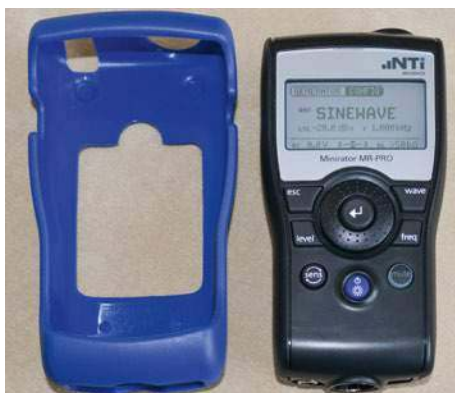
Minirator MR-PRO, w przeciwieństwie do MR2, wyposażony jest w zdejmowaną ochronną osłonę przeciwdrożeńową.
