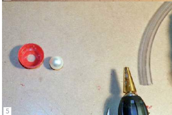
2. Materiały do budowy modelu; 3. Przygotowanie cylindra pompy; 4. Dolny zawór kulowy pompy; 5. Górny zawór, będący częścią tłoka
