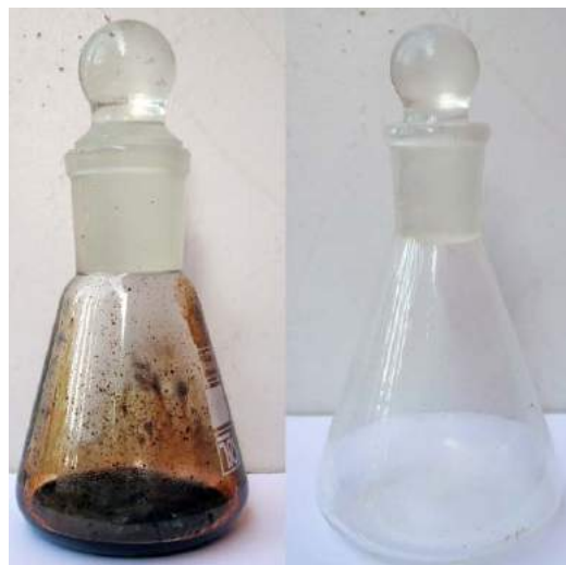
2. Prosta wytwornica chloru. Po lewej – kolba z nadmanganianem potasu i kwasem solnym, po prawej – kolba z „przełanym” chlorem.
