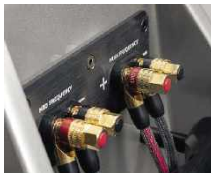
Już przefiltrowane (zwrotnica znajduje się w module niskotonowego) sygnały do głośników średnionowego i wysokotonowego biegną przez regularne, masywne zaciski.
