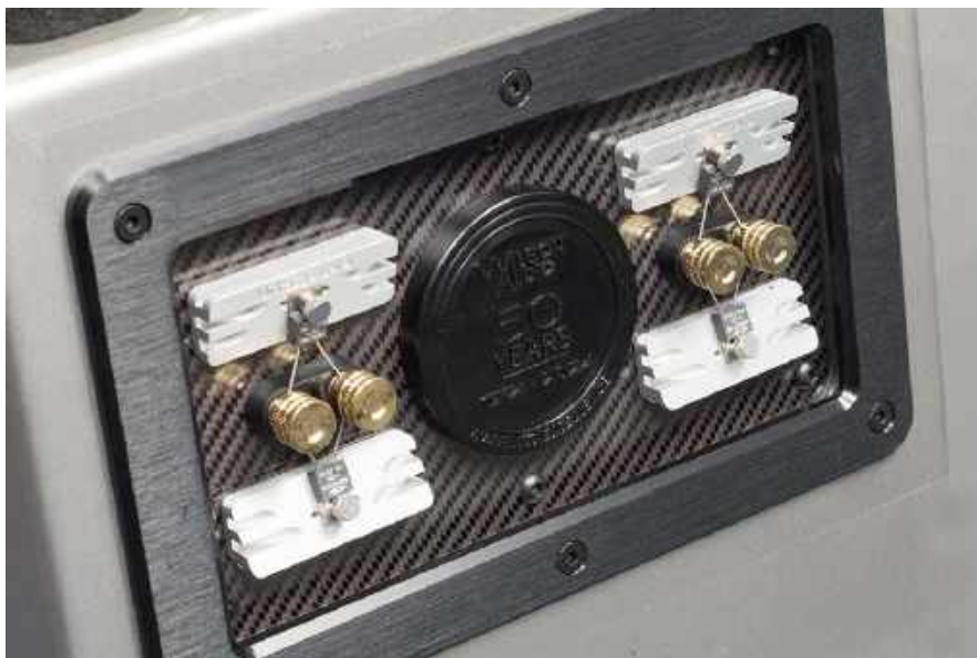
W okienku za dużą szybą wyeksponowano rezystory tłumików (głośników średnionowego i wysokotonowego), a pomiędzy nimi umieszczono okolicznościowy medal.
