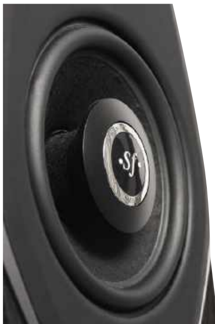
Głośnik średnionowy ma niezwykle korektor fazy – zamiast najczęściej spotykanego kształtu pocisku, rozszerza się, zasłaniając centralną część membrany i tym bardziej wpływając na charakterystyki. Membrana jest pulpą na bazie celulozy.
