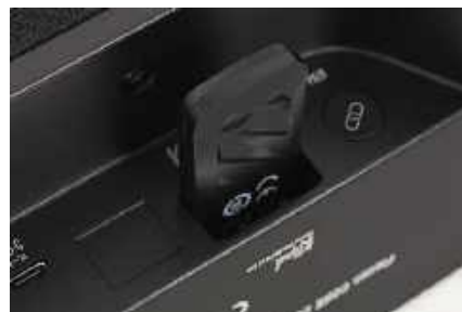
Subwoofer i satelity komunikują się z listwą bezprzewodowo; jest do tego potrzebna przystawka w formie USB, tzw. "dongla", który znajduje się w zestawie.
