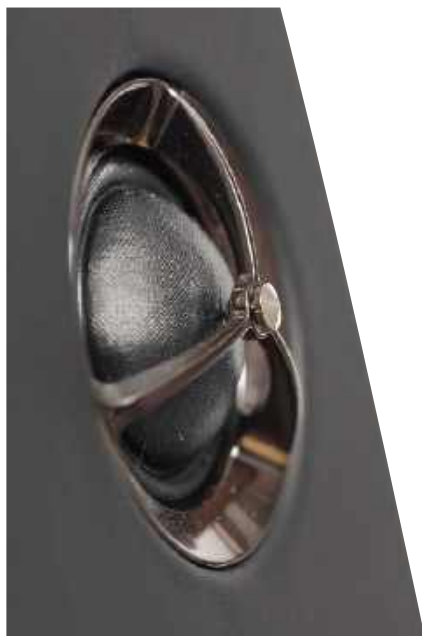
Trójnożny wysięgnik dotyka centralnego punktu kopułki, wpływając na sposób jej poruszania się (jedwabne kopułki wcale nie podążają całą powierzchnią za ruchem cewki), a więc na charakterystykę.
