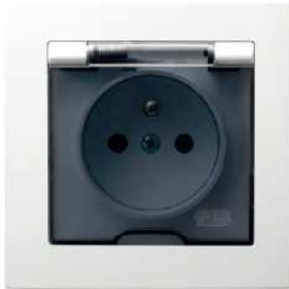
🔦 W łazienkach, montuje się gniazda z pokrywą (bryzgoszczelne) i stopniu szczelności IP44. OSPÉL
