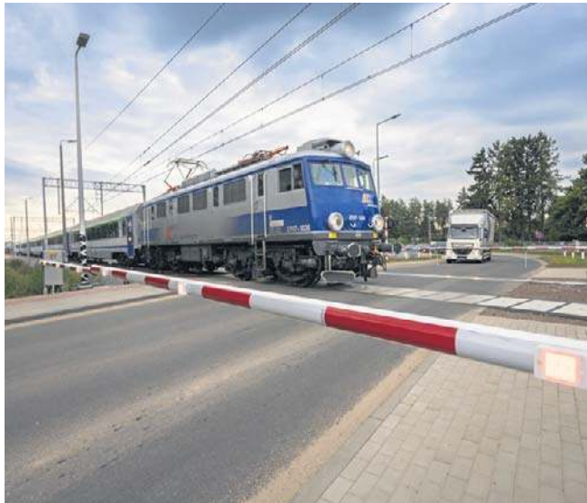
PKP PLI informuje, że roгатki są tak skonstruowane, by w razie zagrożenia życia można je było wyłamać
