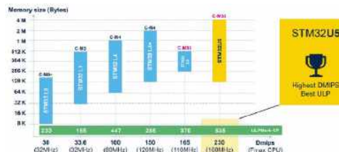
Rysunek 9. Układy STM32U5 łączą ekstremalnie niski pobór mocy z wysoką wydajnością ( https://www.st.com/content/ccc/resource/training/technical/product_training/group1/cd/14/c3/be/5e/dc/4f/25/STM32U5-series-introduction/files/stm32u5-introduction-marketing-presentation.pdf/_jcr_content/translations/en.stm32u5-introduction-marketing-presentation.pdf )
