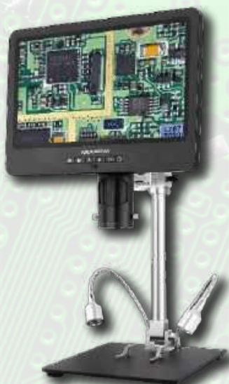
AT-AD246S-M Mikroskop cyfrowy 7 cali z powiększeniem: 60...240×, 18...720×, 1560...2040× ANDONSTAR AD246S-M
