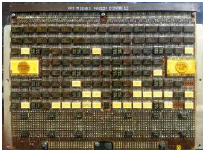
Fotografia 1. Płytkę drukowaną jednego z komputerów (IBM AP-101S) promu kosmicznego NASA. Powłoka konformalna musi spełniać szczególnie surowe wymagania do pracy w kosmosie, nawet jeśli nie będzie narażona na działanie próżni
