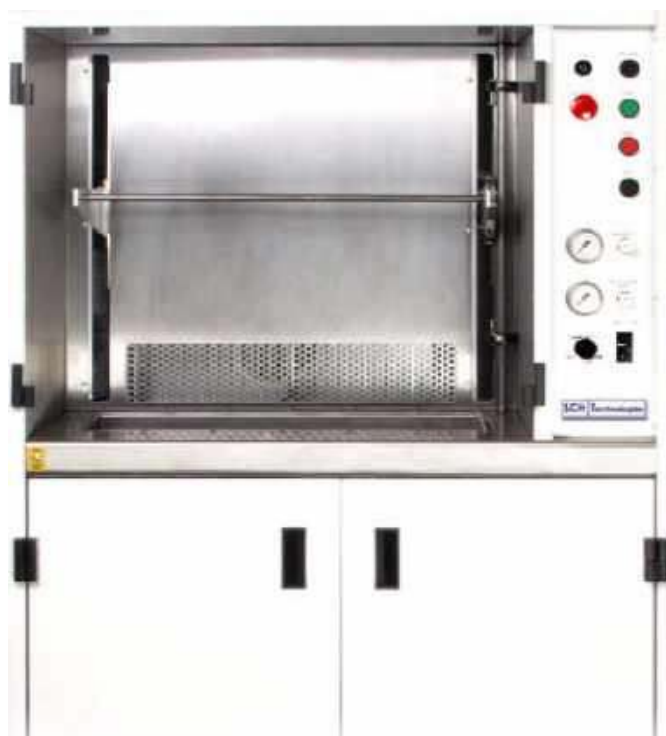
Fotografia 3. Maszyna do nakładania powłok konformalnych przez zanurzenie
