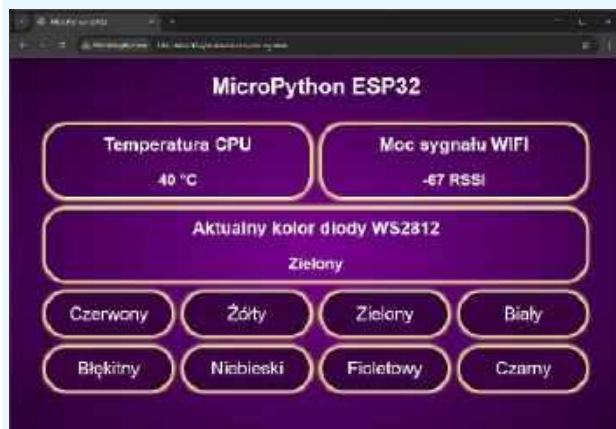
Rysunek 1. Przeglądarka Chrome ze stroną internetową wygenerowaną przez ESP32
