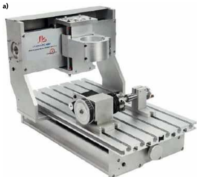
Fotografia 29. Frezarka CNC 3018 z Chin. Zbyt kłopotliwa do normalnej pracy
