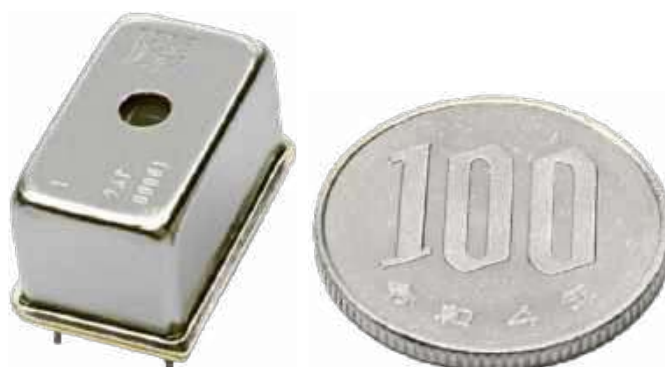
Fotografia 1. Widok spektrometru z serii Micro marki Hamamatsu [1]
