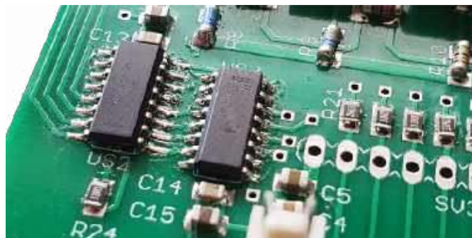
Fotografia 2. Układ 74HC595 uszkodzony zbyt wysokim napięciem zasilającym
