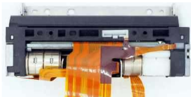
Fotografia 12. Moduł drukarki termicznej z wbudowanym obcinaczem automatycznym. Główna taśma FPC udostępnia zasilanie i sygnały logiczne głowicy, przewody silnika napędowego i połączenia z czujnikami, zaś druga, węższa taśma obsługuje silnik i czujnik obcinacza papieru
