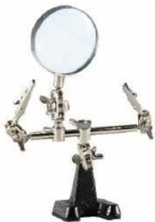
Fotografia 8. Klasyczna „trzecia ręka”, szczególnie użyteczna przy lutowaniu przewodów i złączy
