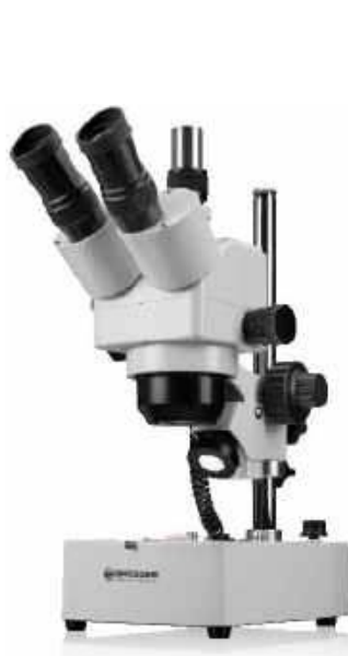
Fotografia 37. Stereoskopowy mikroskop optyczny Bresser Advance ICD
