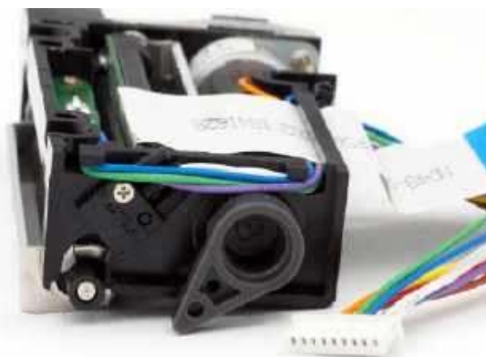
Fotografia 9. Dźwignia zwalniająca zatrzask mocujący wałek. Po lewej stronie widoczny jest elektromechaniczny czujnik obecności wałka
