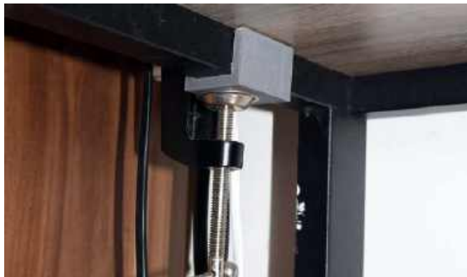
Fotografia 32. Mocowanie lampy kreślarskiej do blatu za pomocą wydruku 3D
