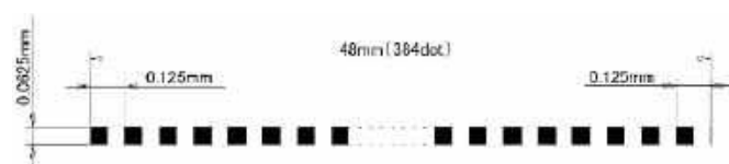
Rysunek 2. Szczegóły wymiarowe pojedynczej linii wydruku [1]
