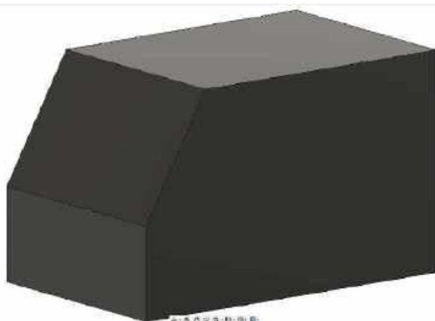
Rysunek 1. Bryła projektowanej obudowy zaprojektowana z użyciem porporcji złotego podziału
