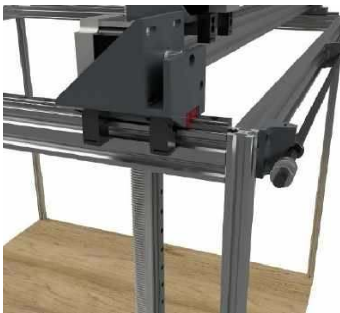
Rysunek 2. Wizualizacja napędu osi Y
