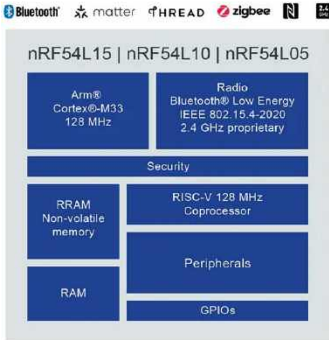
Rysunek 1. Uproszczony schemat blokowy układów z rodziny nRF54L
