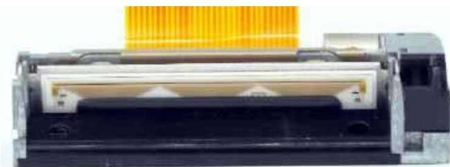
Fotografia 7. Moduł mechanizmu termicznego z wyjętym wałkiem napędowym. Widoczna cała głowica termiczna na podłożu ceramicznym
