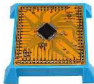
Fotografia 13. Płytkę na dedykowanej podstawie, wykonanej na drukarce 3D
