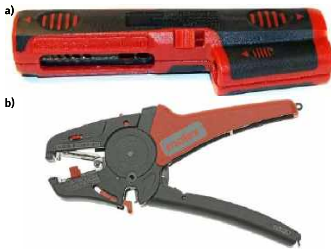
Fotografia 18. Ściągacze do izolacji: ręczny marki Parkside (a) i profesjonalny ściągacz automatyczny Molex 638171100 (b)
