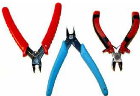
Fotografia 17. Tanie cążki w dwóch wariantach. Na dwóch parach widać ślady zużycia
