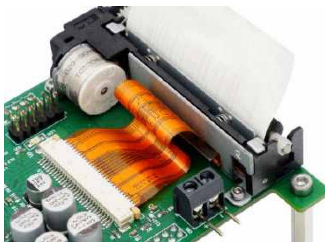
Fotografia 17. Zestaw ewaluacyjny z zamontowanym modułem termicznym
