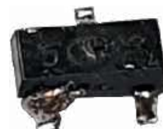
Fotografia 1. Przeciążony tranzystor BC807
