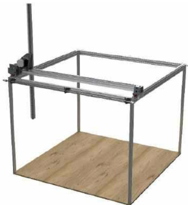
Rysunek 1. Pierwsza wizualizacja konstrukcji robota
