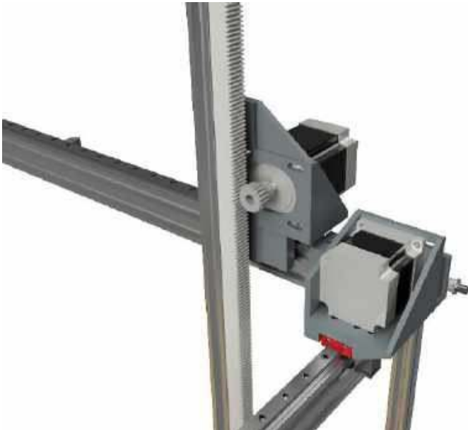
Rysunek 3. Wizualizacja napędu osi Z i X
