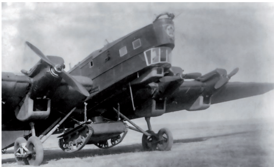
▲ Samolot TB-3 z silnikami M-34R z 3. Brygady Lotniczej Specjalnego Przeznaczenia, kwiecień 1937 roku. Pod samolotem jest podwieszony lekki czołg pływający T-38. W tym czołgu gąsienice nie wymagały dodatkowych zabezpieczeń.
