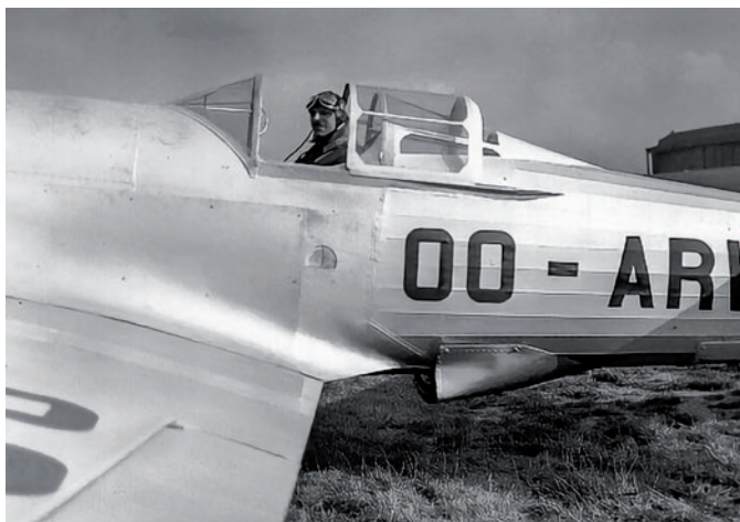
▲ Renard R.36 został wyposażony w otwieraną kabinę pilota.
