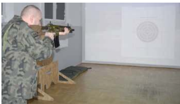
System opiera się na laserowych symulatorach (replikach) broni strzeleckiej wyposażonych w urządzenia laserowe klasy I emitujące niewidzialną wiązkę światła zgodnie z Normą PN-EN 60825-1:2014 oraz na wirtualnej rzeczywistości. Umożliwia on jednocześnie udział w szkoleniu do czterech osób, w różnych pozycjach (stojąca, leżąca, klęcząca) i przy użyciu różnych rodzajów broni w tym samym czasie, zależnie od rozmiaru wyświetlanego obrazu
