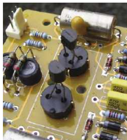
Rysunek 55. Większość japońskich tranzystorów o niskim poziomie szumów ma kolektory pośrodku. Należy je umieścić w gniazdach T05, jak pokazano tutaj
