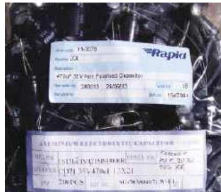
Rysunek 45. Bipolarne kondensatory elektrolytyczne mają znikome zniekształcenia, ale mogą ulec degradacji, jeśli nie są używane. Wszystkie te kondensatory Suntan prawie eksplodowały podczas przechowywania
