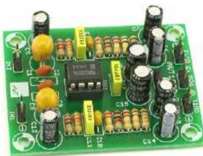
AVT1023 Przedwzmacniacz gramofonowy o charakterystyce RIAA https://sklep.avt.pl/avt1023.html
