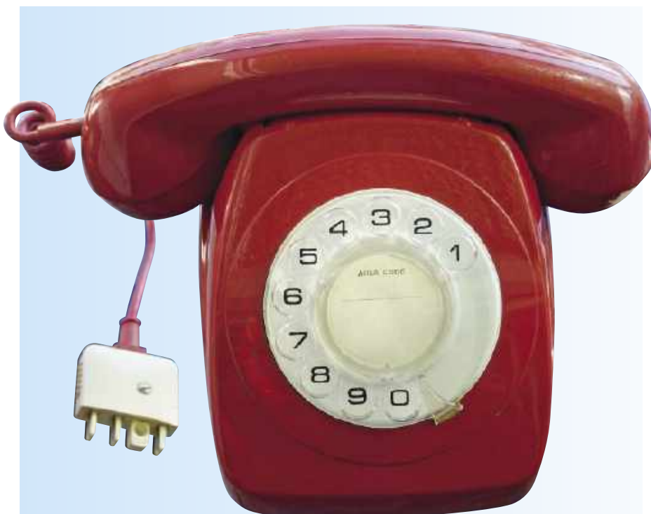
Telefon „batphone” jest przykładem starego telefonu analogowego, który może być używany z urządzeniem Tele-com. Warto pamiętać, że nie wszystkie telefony analogowe mają obrotową tarczę, niektóre mają zamiast niej klawiaturę z przyciskami – oba typy będą działać poprawnie
