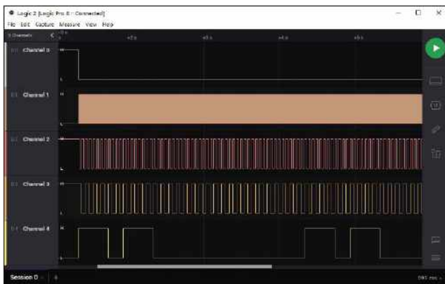
Rysunek 3. Zrzut ekranu z analizatora stanów logicznych, pokazujący, jak działa obwód generowania standardowego sygnału dzwonienia. Ch0 to linia „Cadence Start” (aktywny niski stan), Ch1 to przebieg prostokątny o częstotliwości 200 Hz na wyjściu O13 układu IC5, Ch2 to sygnał 20 Hz ze nóżki 12 układu IC6, Ch3 to sygnał sterujący 10 Hz podawany na nóżkę 14 układu dostępnego w punkcie TP5, a Ch4 to wynikowy sygnał wzorca sygnału dzwonienia, występujący na nóżce 10 układu IC10c (z odwróconą polaryzacją, a więc aktywny jest stan wysoki). Na rysunku przedstawiono standard AU
