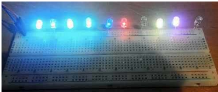
Rysunek 2. Warunki, w jakich testowano zachowanie się diod podłączonych wprost do koszyeczka z dwiema bateriami AA, aż do czasu ich rozładowania (około 40 godzin)
