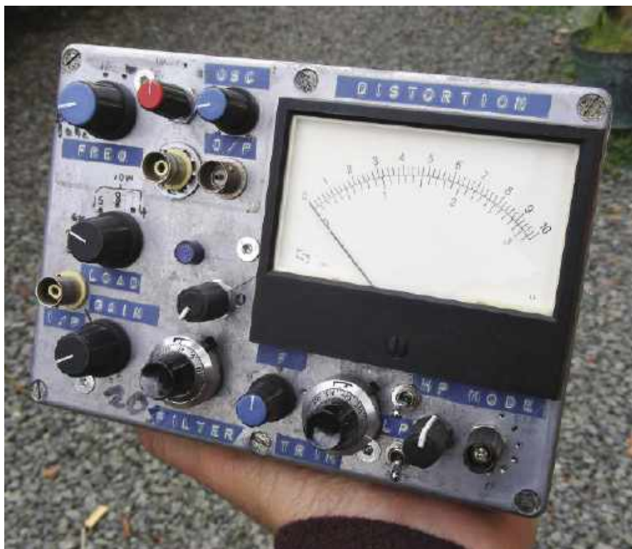
Rysunek 53. Analizator zniekształceń Linsley-Hood służył mi przez 25 lat
