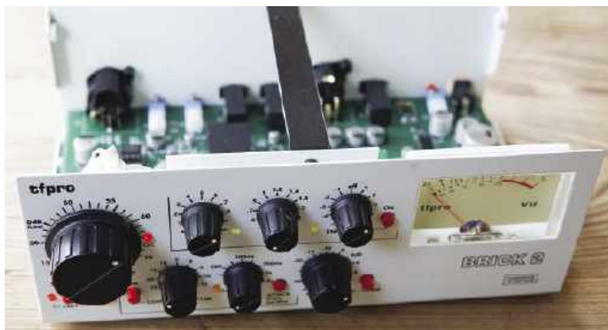
Rysunek 57. Ted Fletcher Brick to niesamowity przedwzmacniacz mikrofonowy i procesor do studyjnych mikrofonów pojemnościowych, ale nie nadaje się do niskich impedancji, stąd podana tutaj konstrukcja zastępcza
