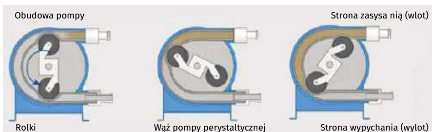
Rysunek 3. Rysunek obrazujący działanie pompy perystaltycznej
