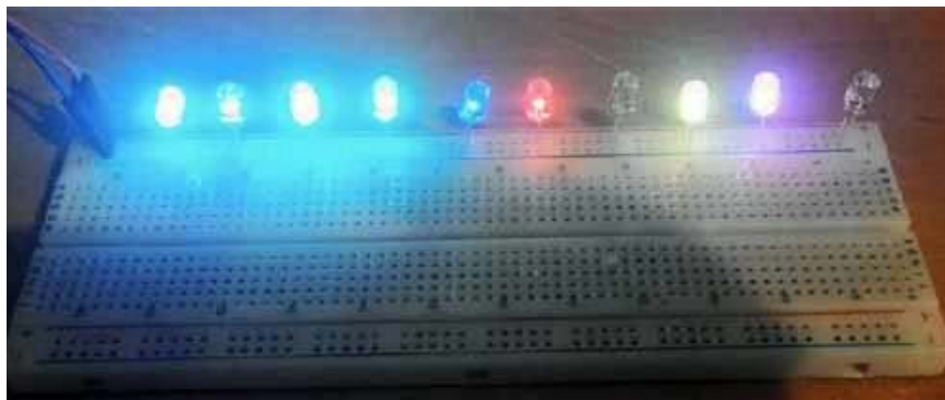
Rysunek 2. Warunki, w jakich testowano zachowanie się diod podłączonych wprost do koszyczka z dwiema bateriami AA, aż do czasu ich rozładowania (około 40 godzin)
