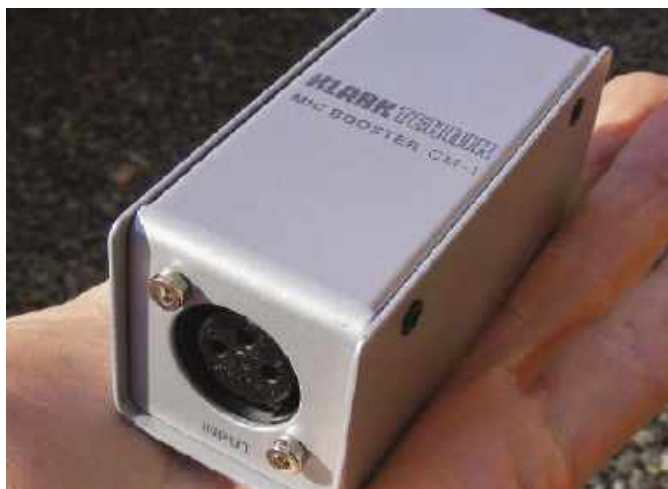
Rysunek 56. Niskoimpedancyjny blok wzmacnienia z zasilaniem fantomowym; musiał on zostać włożony pomiędzy mikrofon niskoimpedancyjny RE20 i przedwzmacniacz Teda Fletchera, aby uzyskać przyzwoity stosunek sygnału do szumu
