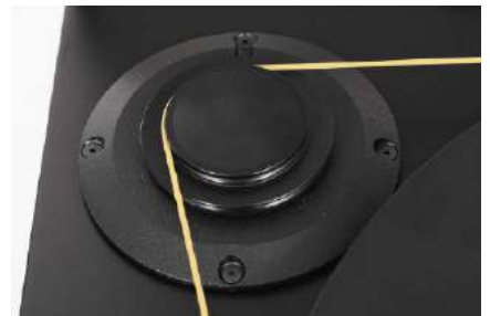
Silnik jest osadzony na elastycznej podstawie, zmiana prędkości obrotowej wymaga przełożenia paska na sąsiednie koło.
