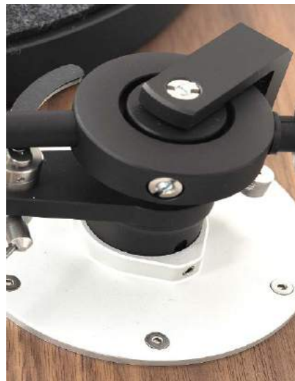
W komplecie regulacji nie zabrakło kąta VTA - wysokość kolumny możemy zmieniać po poluzowaniu blokad w dolnej części korpusu.
