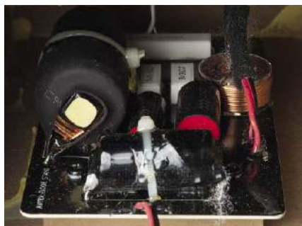
Wyrównana charakterystyka przetwarzania to również zasługa zwrotnicy.
