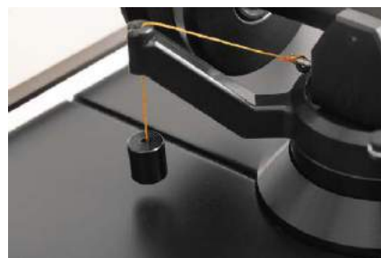
Ciężarek układu anti-skating zawieszono na pomarańczowym sznureczku.
