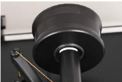
Rekomendowane ustawienie przeciwwagi uzyskamy dosuwając ciężarek do znacznika na rurce.
