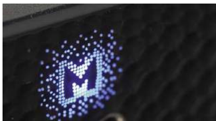
Podświetlane logo sygnalizuje etap rozruchu (kolor zielony) i regularną pracę (niebieski).
