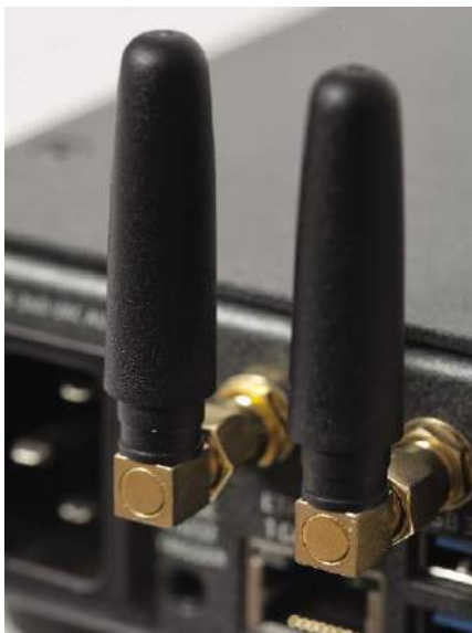
Sekcja sieciowa wykorzystuje LAN oraz Wi-Fi, jest też antena odbiornika Bluetooth.
