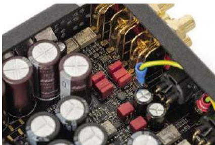
Obok nowoczesnej elektroniki cyfrowej pojawiła się sekcja przedwzmacniacza gramofonowego.
