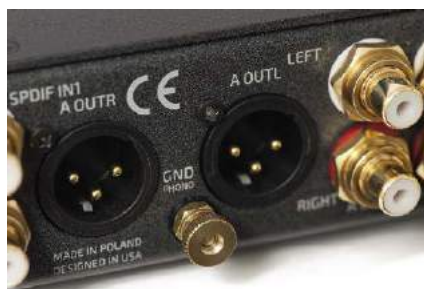
Począwszy od przetwornika C/A, tor sygnału jest zbalansowany, stąd wyjścia XLR nie są do parady.
