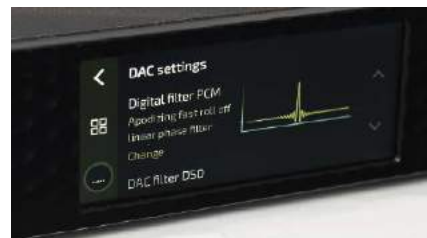
Kolorowa, dotykowa matryca to na razie jedyny sposób dotarcia do bardziej zaawansowanych ustawień.
