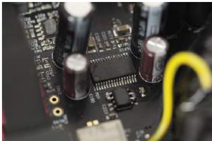
Dostępne są dwa tryby regulacji głośności: cyfrowy (wbudowany w przetwornik C/A) i analogowy (układ scalony JRC MUSES).
