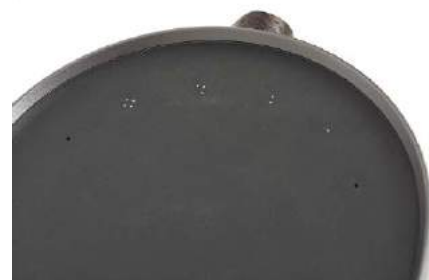
Dodatkową atrakcją są cztery programowalne przyciski szybkiego wyboru (mogą np. uruchamiać listy odtwarzania), obok nich umieszczono mikrofony kalibracyjne.
