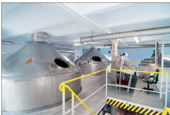
Warzelnia Browaru Zamkowego w Raciborzu. To tutaj zaczyna się proces produkcji piwa.
