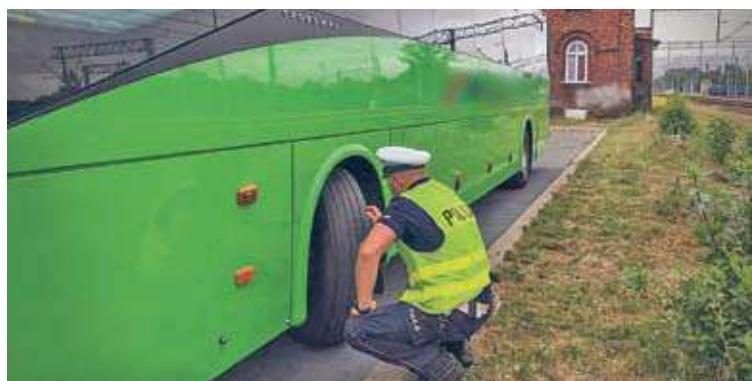
Pojazd miał nadmiernie zużytą rzeźbę bieżnika osi przedniej i spękaną opony (fot. lubuska policja)
