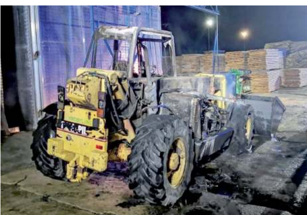
Przyczyną pożaru było prawdopodobnie zwarcie instalacji elektrycznej w ładowarce teleskopowej
