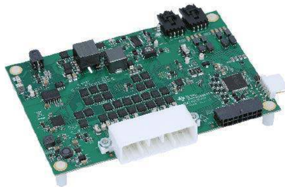
Fotografia 19. Płyta ewaluacyjna EM1402EVM (t.ly/mJDFc)
