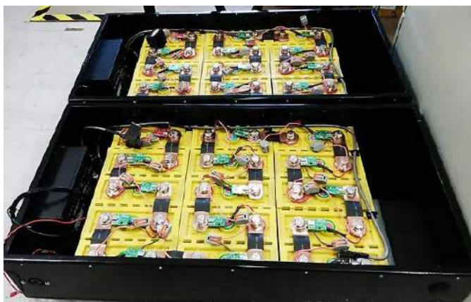
Fotografia 11. Pakiet akumulatorów współpracujący z modułowym systemem BMS (t.ly/xrWXg)
