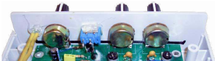
Fotografia 7. Montaż przedniego panelu odbiornika w obudowie
