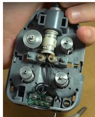
Fotografia 6. Wnętrze głowicy wymiennego narzędzia robota da Vinci (t.ly/vZUbH)
