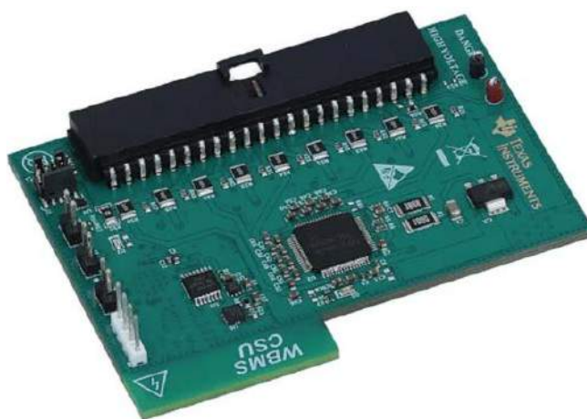
Fotografia 12. Moduł podrzędny bezprzewodowego systemu BMS – płytka ewaluacyjna CC2662RQ1-EVM-WBMS (t.ly/UT2zs)
