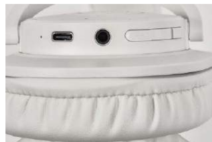
Wszystkie gniazda i przyciski zostały umieszczone na lewej muszli.
