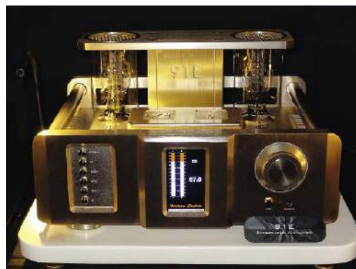
Kłękajcie narody – Kondo Kaga-ra. W stopniu wyjściowym para 12AU-7/6SN7 w konfiguracji równoległego single-ended, moc 50 W, cena... zapomnij.
