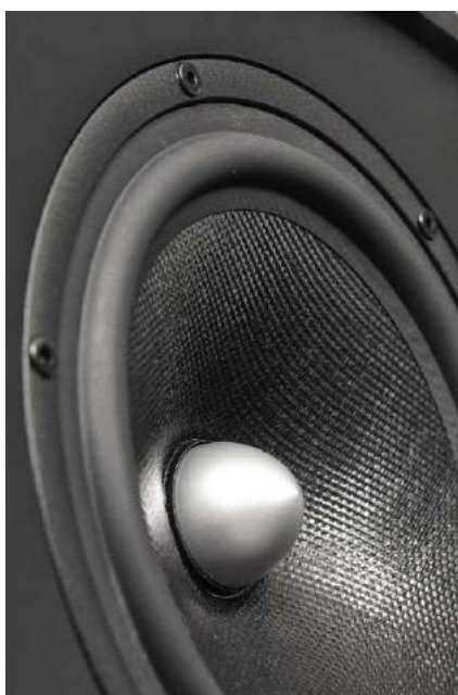
... podobnie jak wyjątkowo duży, 20-cm średniotonowy – z membraną polipropylenową i korektorem fazy.
