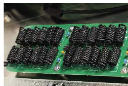
Zdecydowanie autorskim rozwiązaniem jest arsenał obwodów redukujących zakłócenia RFI.
