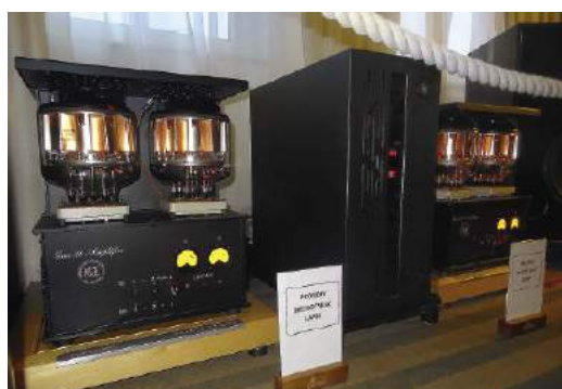
Monobloki Jadis JA170 na lampach KT180 – cztery w podwójnym układzie push-pull oddają 85 W w klasie A. Na drugim planie wzmacniacz Destination Audio Nika, formalnie zintegrowany, ale z odseparowanym zasilaniem.
