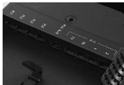
Złącza systemu PowerLink służą do współpracy z dodatkowymi kolumnami B&O, są też aż cztery sieciowe gniazda LAN (jedno specjalnie dla telewizorów LG).
