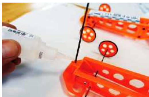
Sprężynę należy dobrze wkleić klejem cyjanoakrylowym
