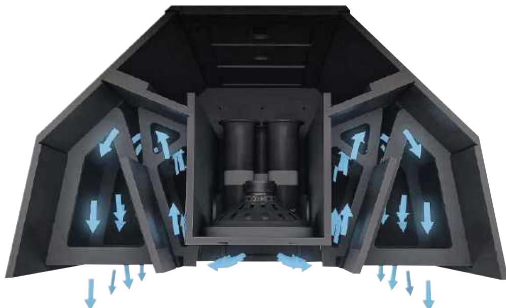
Strzałki ilustrują bieg ciśnienia w tubowym labiryncie, prowadzącym od głośników i wylotów tuneli bas-refleks (znajdują się poniżej)
