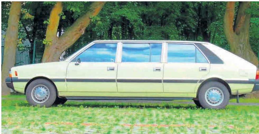
Gdański Polonez Jamnik w całej okazałości. Środkowe drzwi wykonano z części drzwi przednich i tylnych. Podłoga i dach zostały przedłużone o 90 centymetrów
