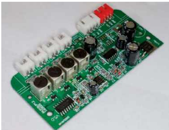
Fotografia 18. Płytką drukowaną kontrolera taniego, uniwersalnego systemu czujników parkowania. Widoczne miniaturowe transformatory strojone, pracujące w torach nadawczych ( https://t.lv/01Y15 )
