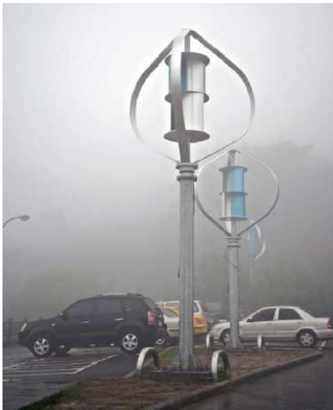
Fotografia 4. Hybrydowa turbina Savonius-Darrieus używana na Tajwanie
