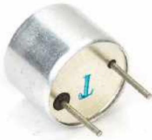
Fotografia 8. Tani nadajnik ultradźwiękowy z widocznym oznaczeniem ( https://t.ly/7esIF )
