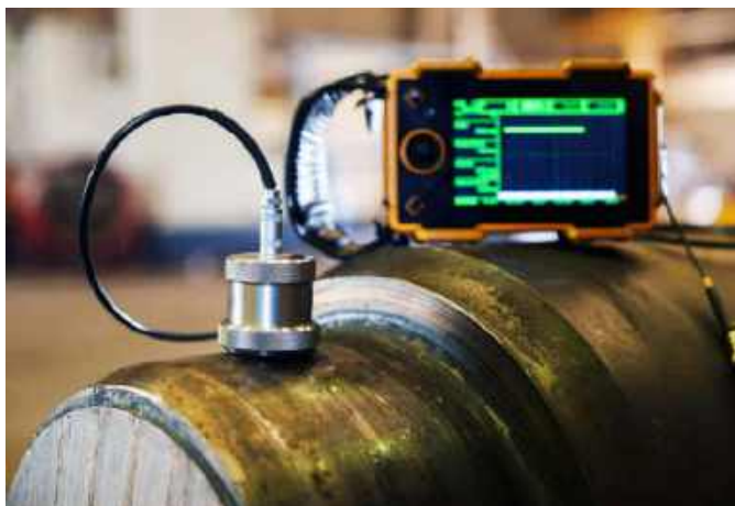
Fotografia 13. Badanie nieniszczące z użyciem przetwornika ultradźwiękowego przyłożonego bezpośrednio do testowanego obiektu ( https://t.ly/QZxSG )
