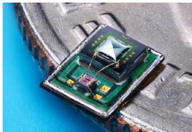
Fotografia 4. Budowa wewnętrzna typowego mikrofonu MEMS ( https://t.ly/ZXhse )
