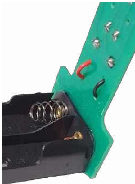
Fotografia 2. Szczegóły montażu koszyka na baterie
