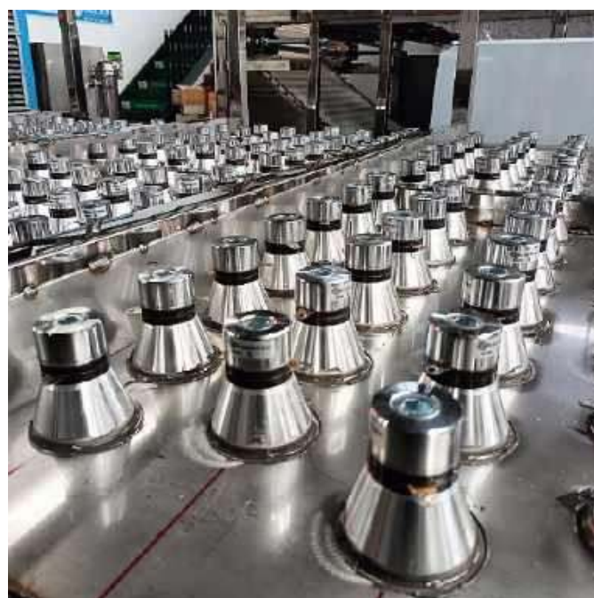
Fotografia 20. Zestaw przetworników zamontowanych do zbiornika przemysłowej myjki ultradźwiękowej dużej mocy ( https://t.ly/R_v3f )
