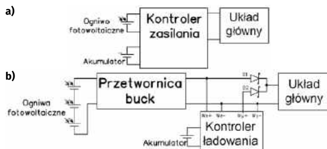
Rysunek 3. Dwa rozwiązania zasilania fotowoltaicznego małej mocy: z kontrolerem zasilania (a) i modułem ładowania akumulatorów z zabezpieczeniem oraz przetwornikiem diodowym (b)
