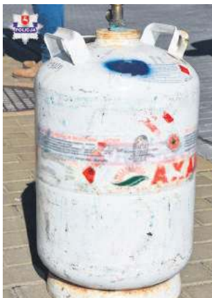
Przyczyną mogło być rozszczelnienie butli
