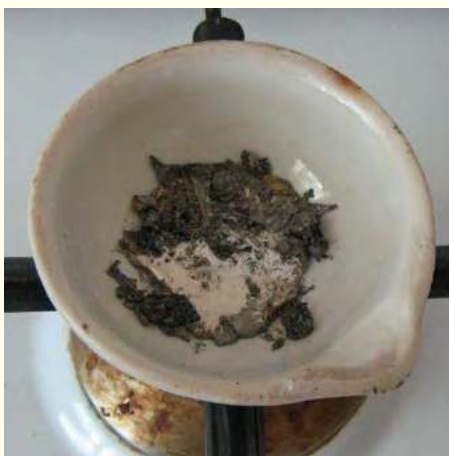
Na powierzchni stopionego ołowiu powstaje nalot tlenku.
