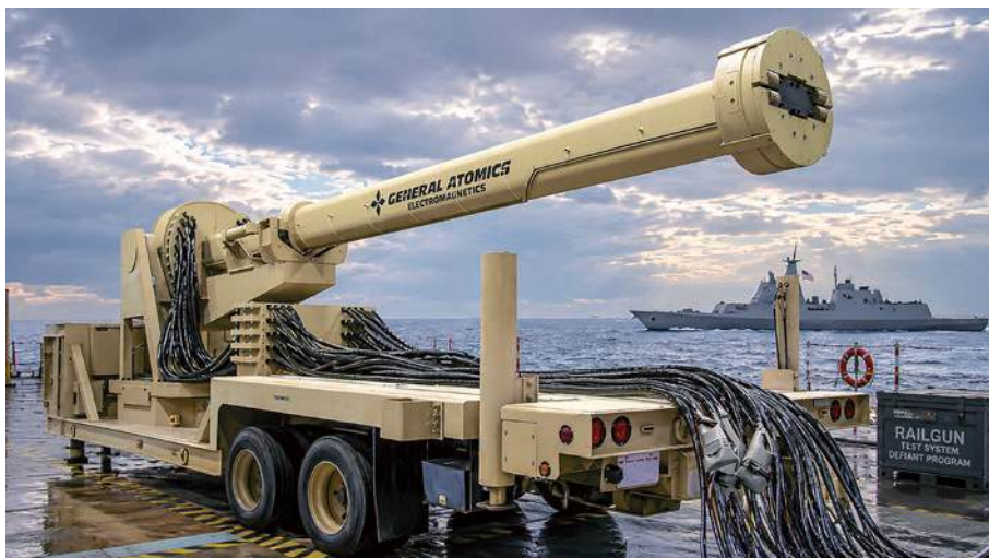
▲ Mobilne stanowisko testowe armaty elektromagnetycznej (railgun) General Atomics. Choć pierwotny program nie doprowadził do wdrożenia uzbrojenia na okrętach US Navy, zgromadzone doświadczenia oraz rozwój pocisków hipersonicznych sprawiają, że broń elektromagnetyczna nadal pozostaje jedną z rozważanych technologii dla przyszłych ciężkich okrętów nawodnych, w tym pancerników rakietowych typu Defiant (BBGN).
