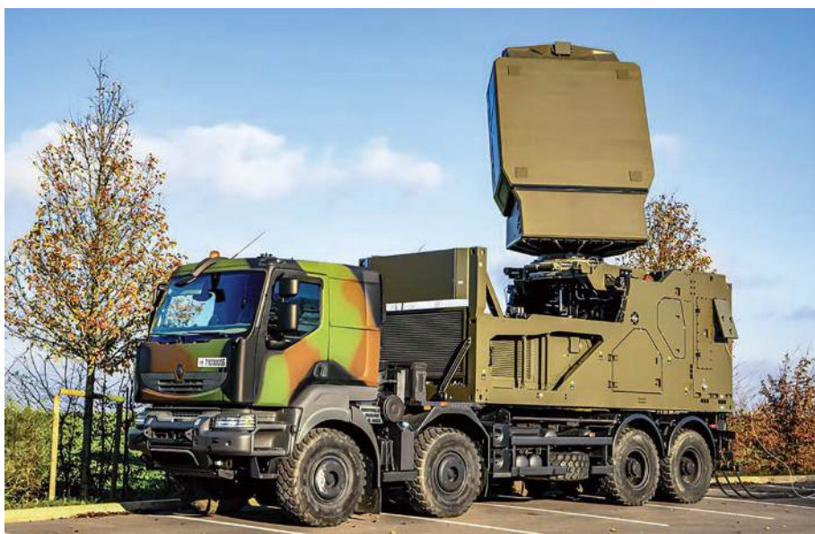
▲ Jedną z ważniejszych zmian w systemie SAMP/T NG będzie zastosowanie nowych radarów. W przypadku konfiguracji francuskiej będą nimi radary Ground Fire 300 .
