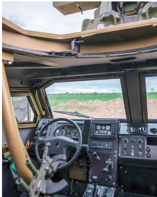
▲ Stanowisko dla kierowcy pojazdu o masie kilkunastu ton odpowiada standardom znanym z samochodów cywilnych, unika się już prostoty i surowości wyposażenia z wojskowych wozów poprzednich generacji.
