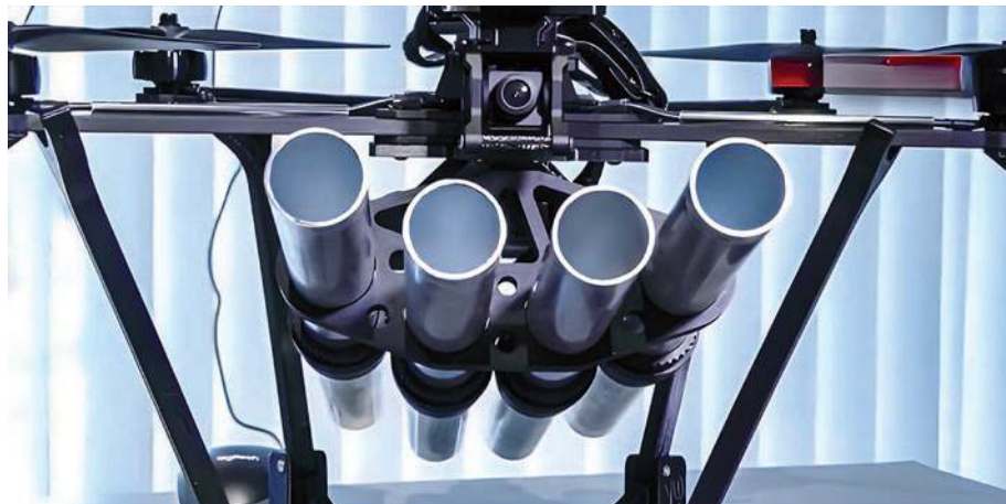
▲ Rosyjski bezzałogowiec Osojed-D , uzbrojony w cztery krótkie lufy załadowane śrutem, jako przykład powietrznej walki między dronami.
