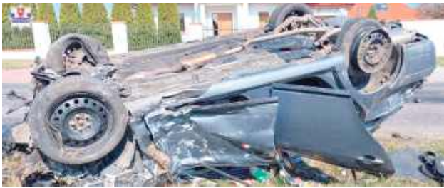
Tak wyglądała toyota po wypadku. Aż trudno uwierzyć, że autem podróżowało dziesięć osób... Według ustaleń śledczych kierowca stracił panowanie nad pojazdem m.in. dlatego, że z prawej tylnej felgi zsunęła się uszkodzona opona
