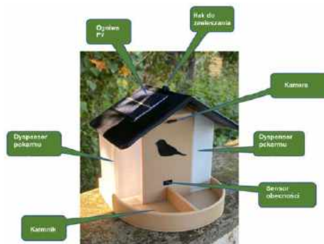
Rysunek 1. Opis elementów konstrukcji karmnika
