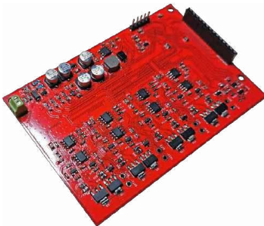
Fotografia 1. Zmontowana płytka główna – strona TOP
