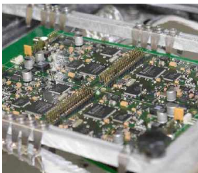
Fotografia 11. Płytki PCB lutowane za pomocą fali
