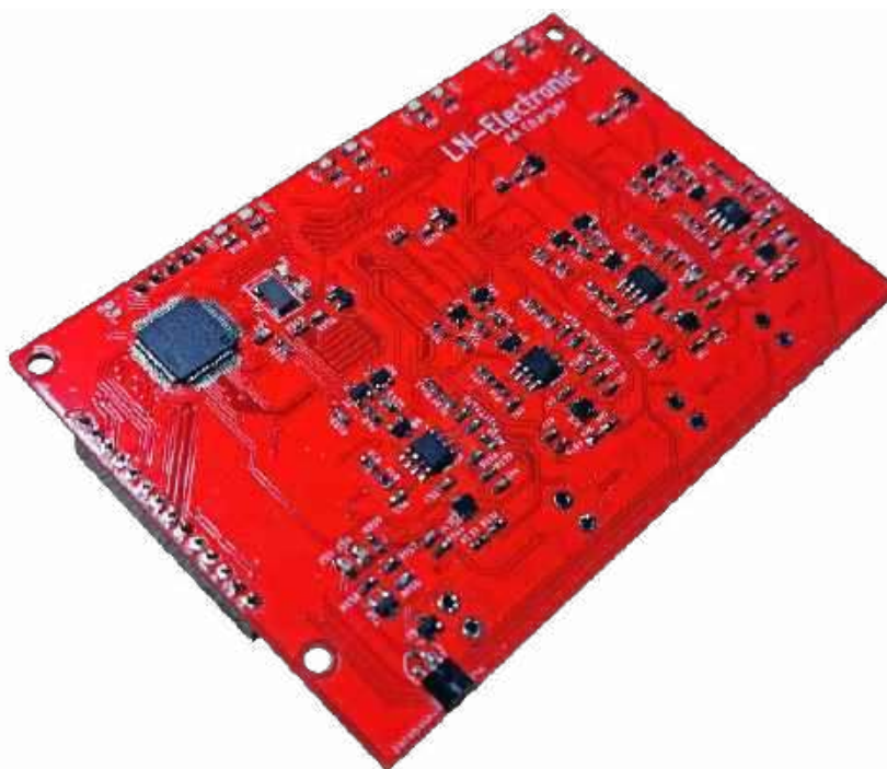
Fotografia 2. Zmontowana płytka główna – strona BOTTOM
