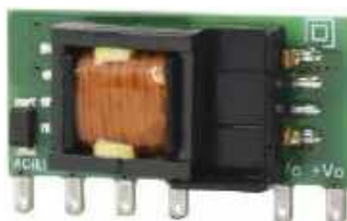
Fotografia 12. Zasilacz subminiaturowy do montażu THT (CUI, http://bit.ly/3qtEas9 )
