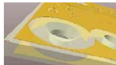
Rysunek 7. Wizualizacja otworu z fazowaniem na płycie PCB
