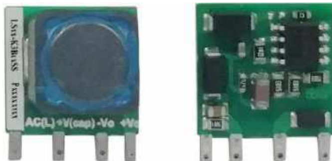
Fotografia 25. Ultraminiaturowy zasilacz nieizolowany LSxx-K3BxxSS marki Mornsun ( http://t.ly/4lfq )
