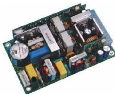
Fotografia 20. Zasilacz modułowy NV-100 marki TDK Lambda ( http://t.ly/hiWG )
