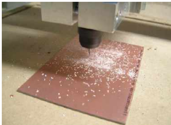
Fotografia 5. Płytkę drukowaną wykonywaną metodą frezowania
