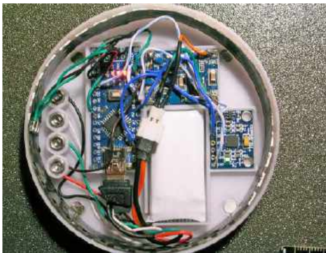
Fotografia 1. Elektronika zamontowana we wnętrzu spinnera
