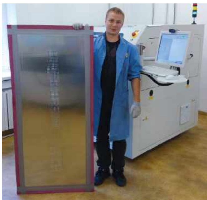
Fotografia 2. Długi szablony w ramie aluminiowej do produktów LED (Semicon Sp. z o.o.)
