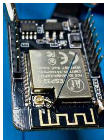
Fotografia 2. Modyfikacja w obwodzie anteny modułu
