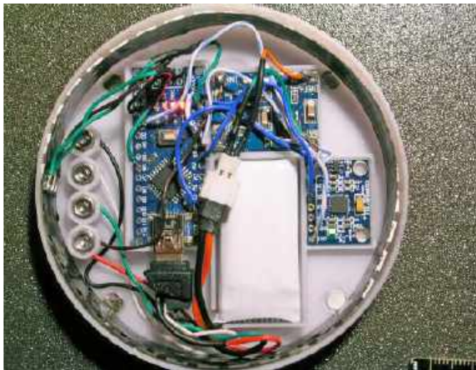
Fotografia 1. Elektronika zamontowana we wnętrzu spinnera
