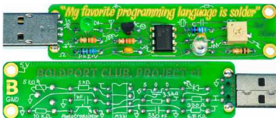
Fotografia 4. W warstwie opisowej od strony lutowania umieściłem schemat obwodu, a na krawędzi płytki dodałem linijkę (zdjęcia dzięki uprzejmości Boldport)
