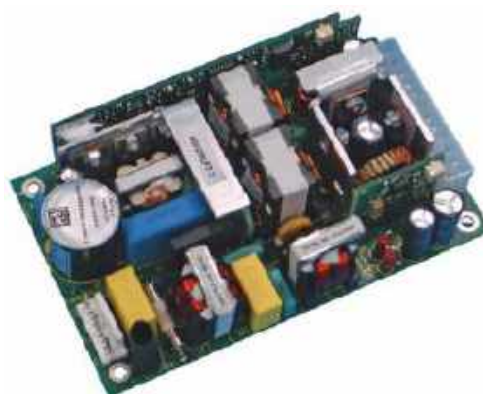
Fotografia 20. Zasilacz modułowy NV-100 marki TDK Lambda ( http://t.ly/hiWG )
