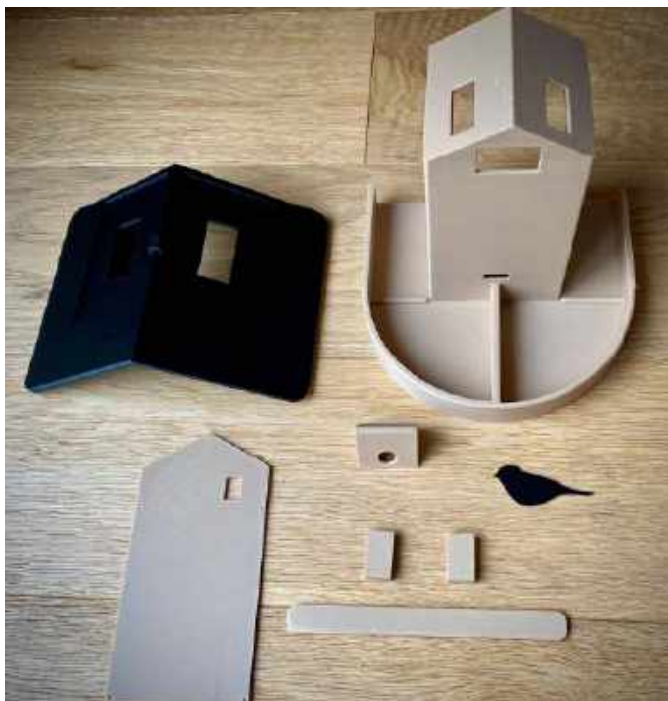
Fotografia 3. Wydrukowane w technice 3D elementy karmnika
