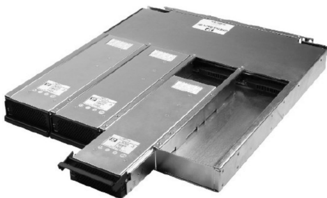
Fotografia 19. Kaseta z zasilaczami z serii GFR o maksymalnej mocy sumarycznej do 6 kW (XP Power, http://t.ly/Hpkc )
