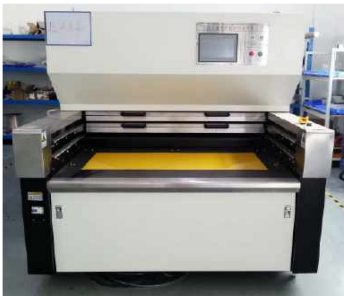
Fotografia 2. Przemysłowe urządzenie do fotolitografii
