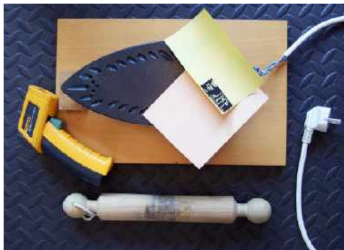
Fotografia 3. Domowe stanowisko do termotransferu
