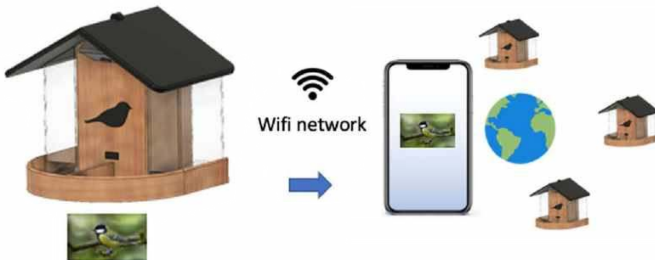
Rysunek 2. Uproszczona zasada działania systemu
