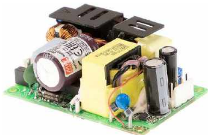
Fotografia 1. Zasilacz open frame bez obudowy (Mean Well, http://bit.ly/3nuS9w1 )
