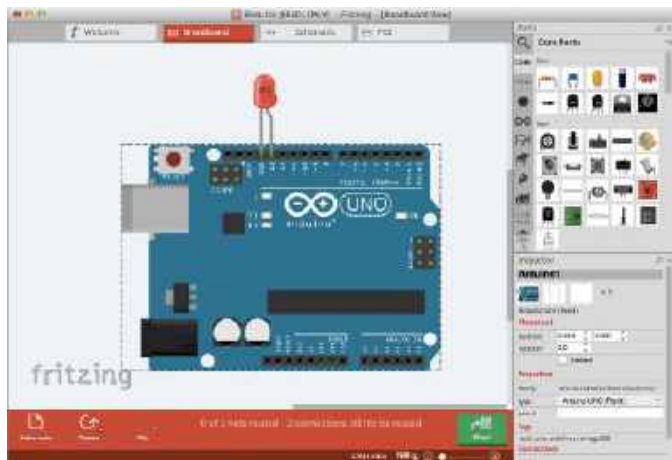
Rysunek 5. Projekt tworzony we Fritzing
