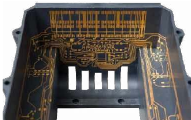
Fotografia 1. Komponent MID z gotową warstwą przewodzącą
