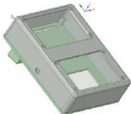
Rysunek 5. Projekt obudowy ładowarki
