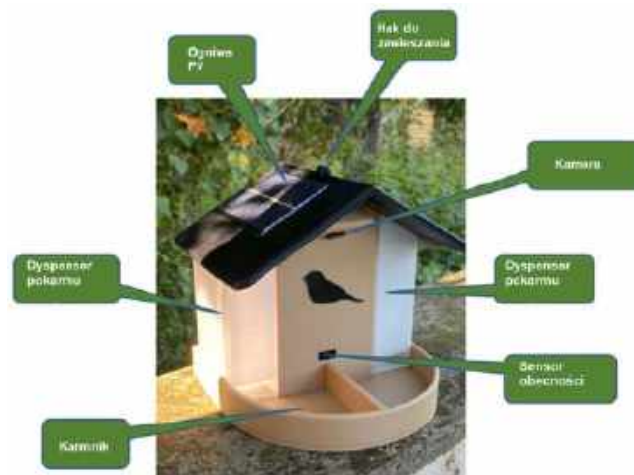
Rysunek 1. Opis elementów konstrukcji karmnika
