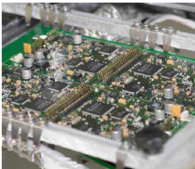
Fotografia 11. Płytki PCB lutowane za pomocą fali
