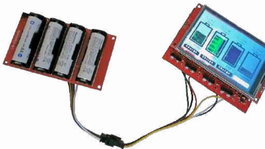
Fotografia 3. Zmontowana płytkę główną z zamontowanym wyświetlaczem i dołączoną płytką z koszykami na akumulatorki
