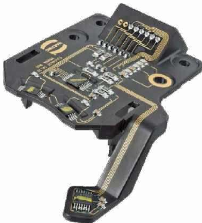
Fotografia 2. Komponent MID z zamontowanymi elementami
