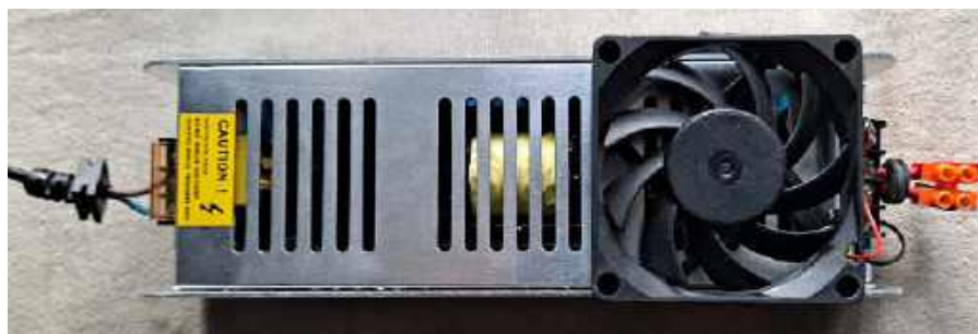
Fotografia 1. Sposób zamontowania wentylatora do zasilacza
