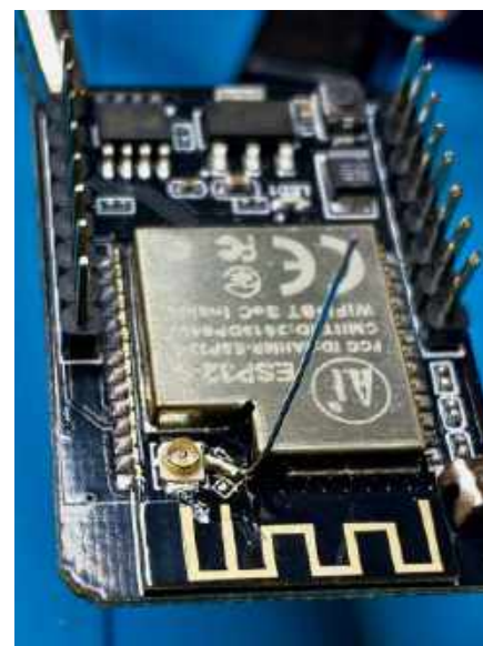
Fotografia 2. Modyfikacja w obwodzie anteny modułu
