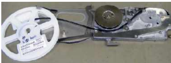
Fotografia 8. Elementy zapakowane w taśmach przeznaczone do maszyny pick and place
